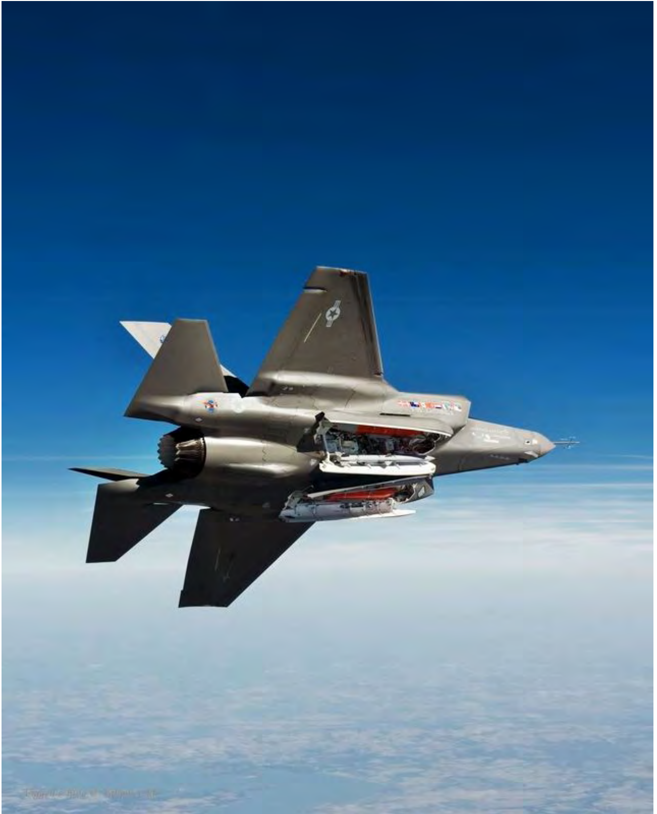
飞行中的 F-35 打开弹舱，可见弹舱内的 JDAM 和弹舱盖板上的 AIM-120D 空空导弹
