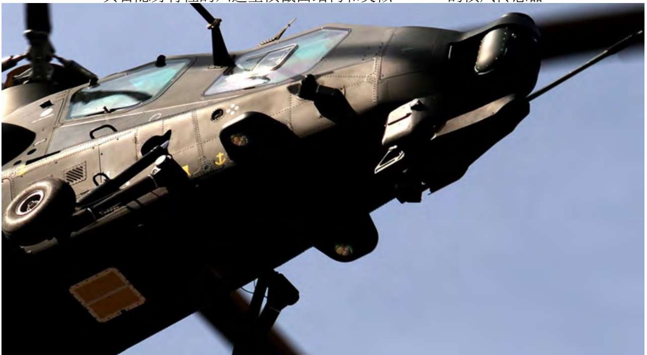
具备隐身特性的六边型横截面结构和类似 AH-64D 的横风传感器
