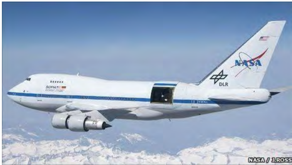
这个机载望远镜能观测到远红外线波长范围的光
