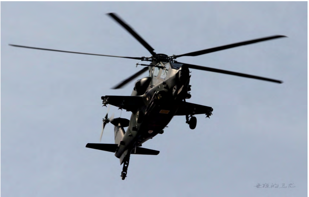
具备隐身特性的六边型横截面结构和类似 AH-64D 的横风传感器
