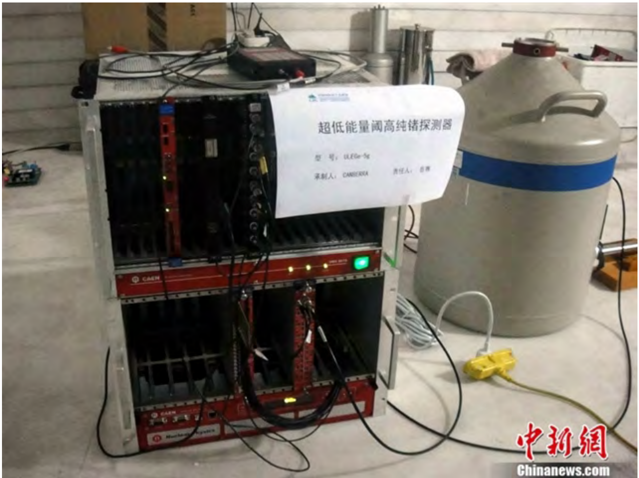
图为用于暗物质探测的超低能量阈高纯锗探测器。中新社记者 杨杰 摄
