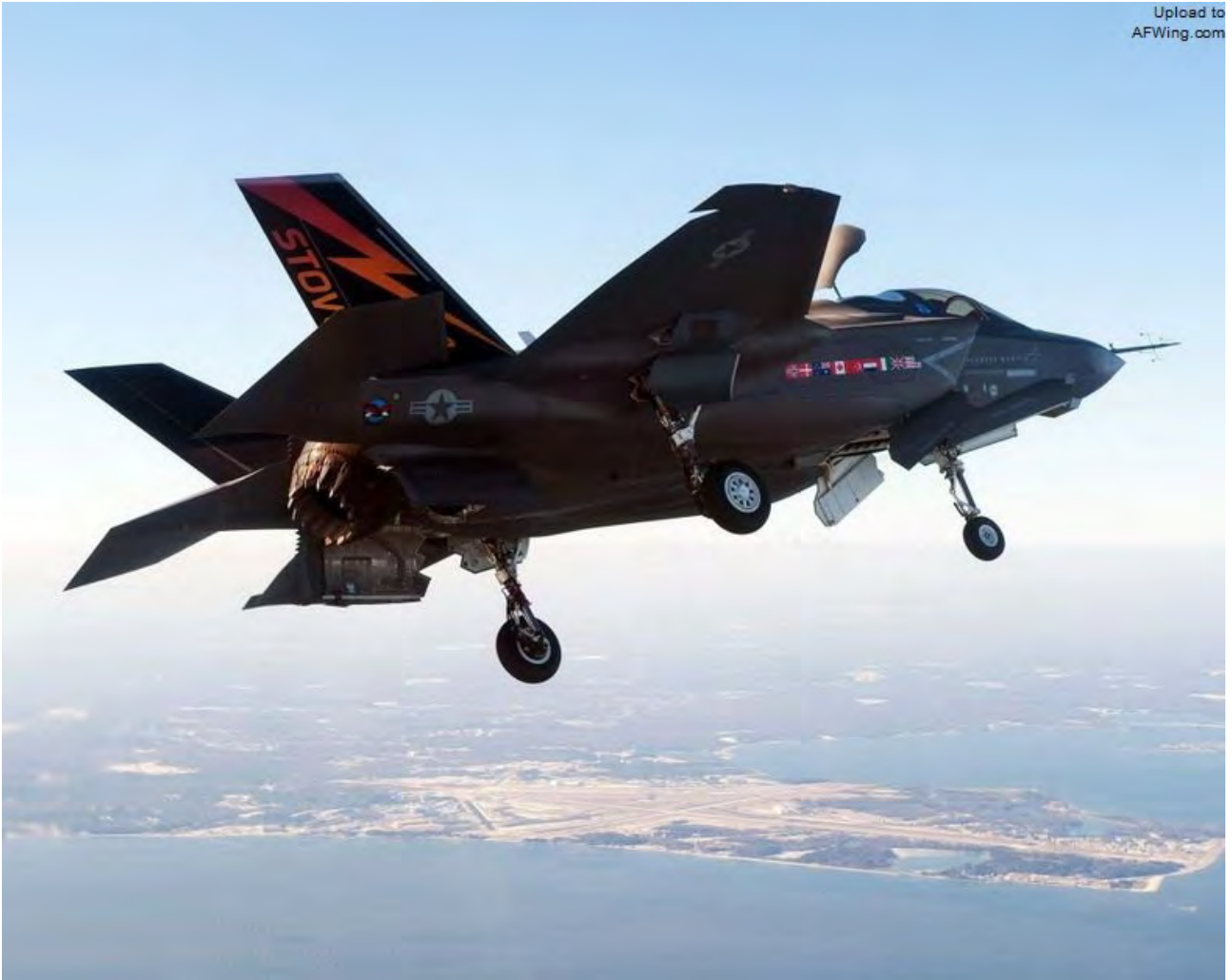
F-35B 采用升力风扇和主发动机推力转向相结合，产生垂直升力
