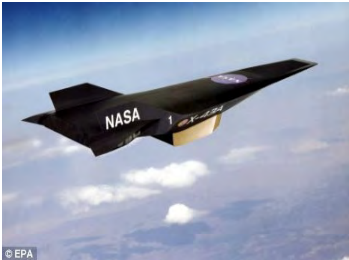
NASA 研制的 X-43A 超燃冲压飞行器最快速度可接近音速七倍。
