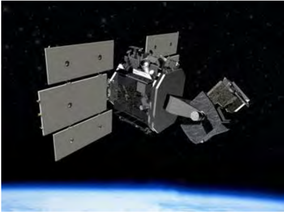
SBSS 卫星艺术想象图，双轴万向常平架上就是高灵敏度光学探测器。
