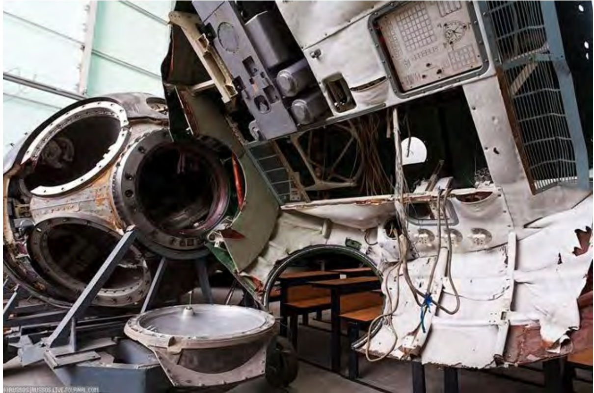
L2 月球轨道舱部分拆解后的情形
