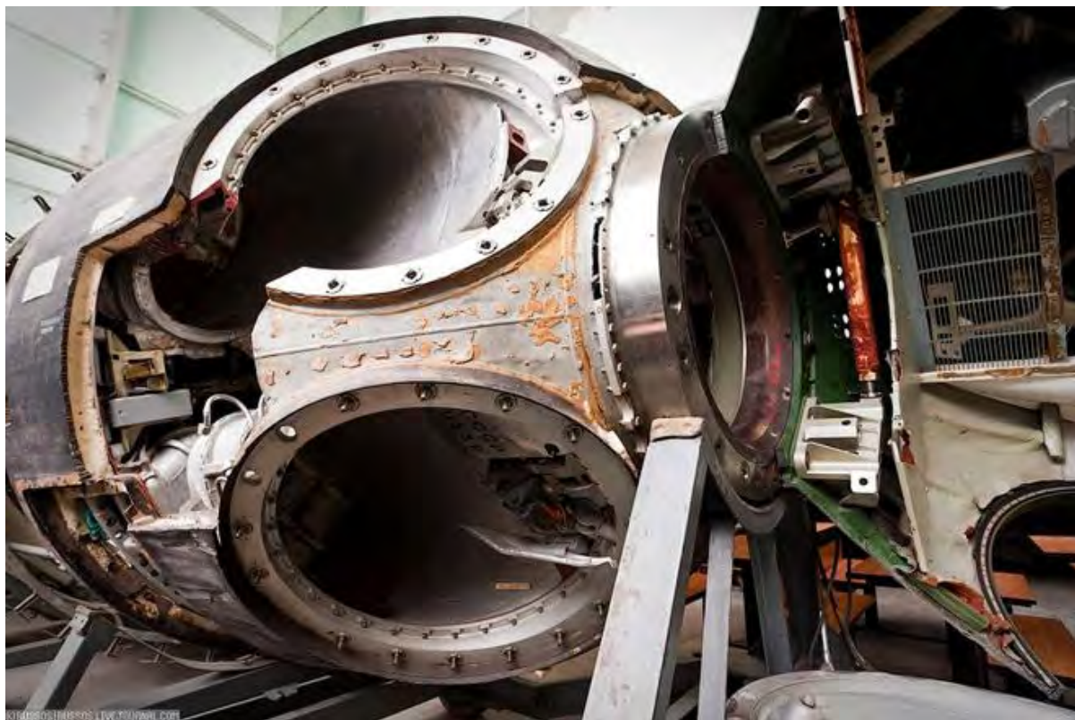
L2 月球轨道舱部分拆解后的情形
