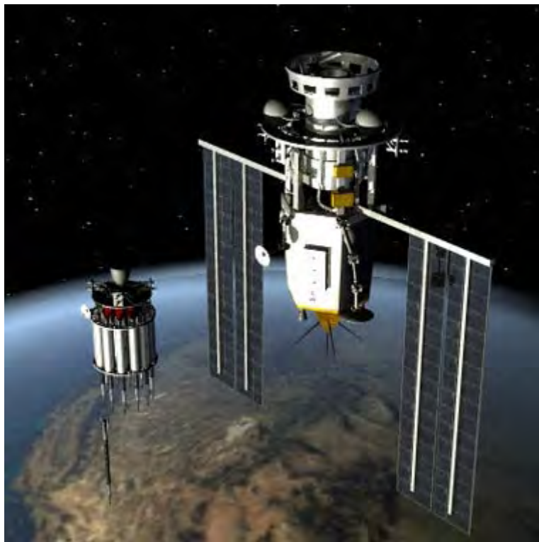
资料图：美国对地攻击卫星方案，对地面发射金属棒，利用超高音速的动能即可摧毁目标。
