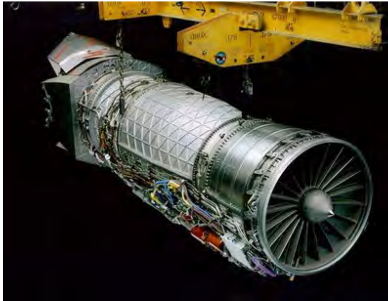
安装矢量喷管的 F119-PW-100
