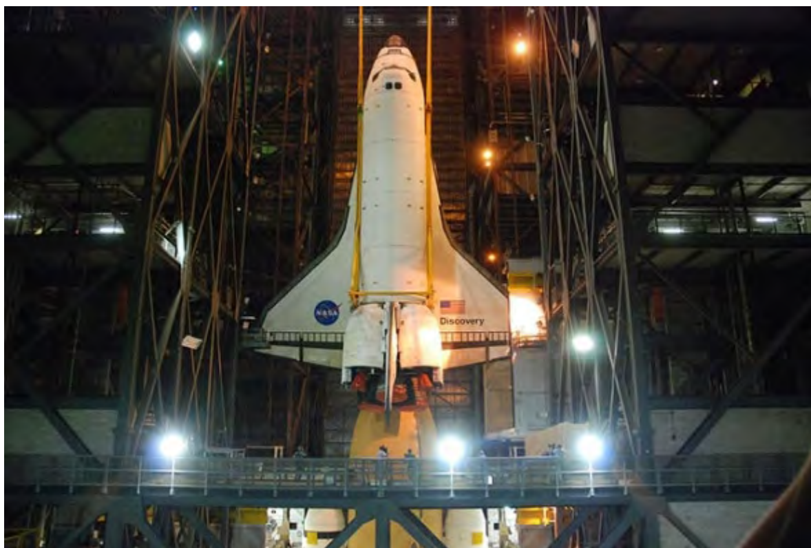
发现号航天飞机被高高吊起，开始进行外部燃料箱和固体助推火箭的安装工作。它将执行 STS-133 飞行任务，前往国际空间站。
