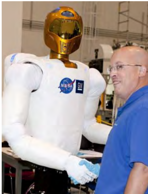
“Robonaut 2” 拥有灵活的双手，能同人类宇航员一样使用工具执行相关的各类太空作业。
