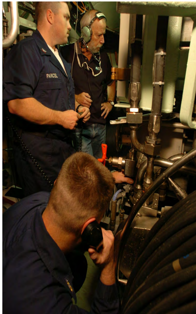
左侧为一种典型的潜用拖线阵收发系统，右侧为工程人员在弗吉尼亚级核潜艇上测试拖线阵系统，黑色线缆为 TB-16 的拖缆。
