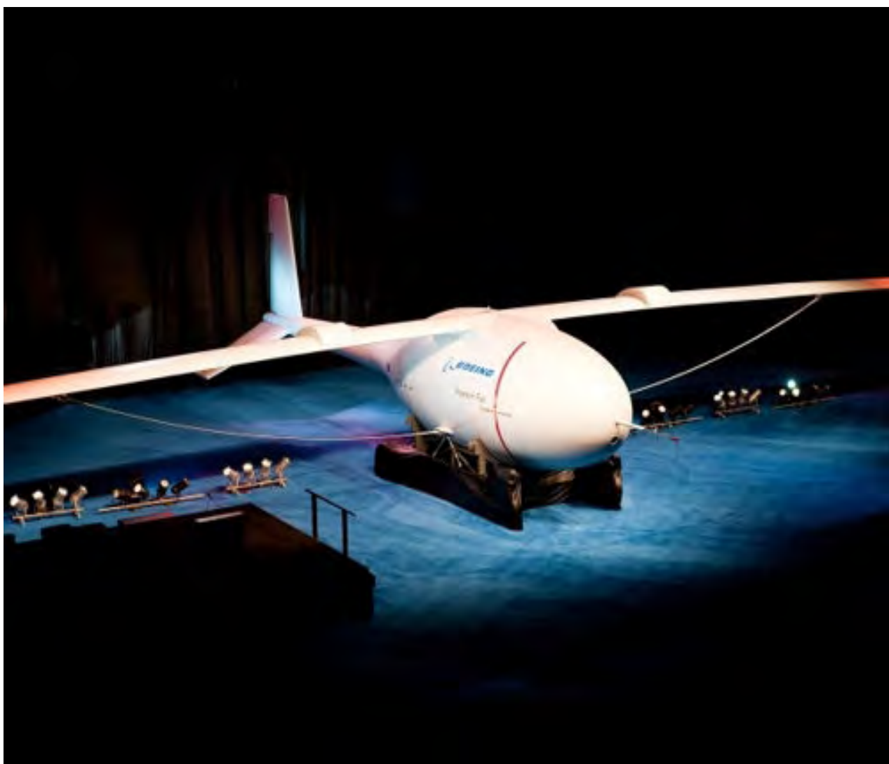
“鬼眼”（Phantom Eye）氢动力无人侦察机
