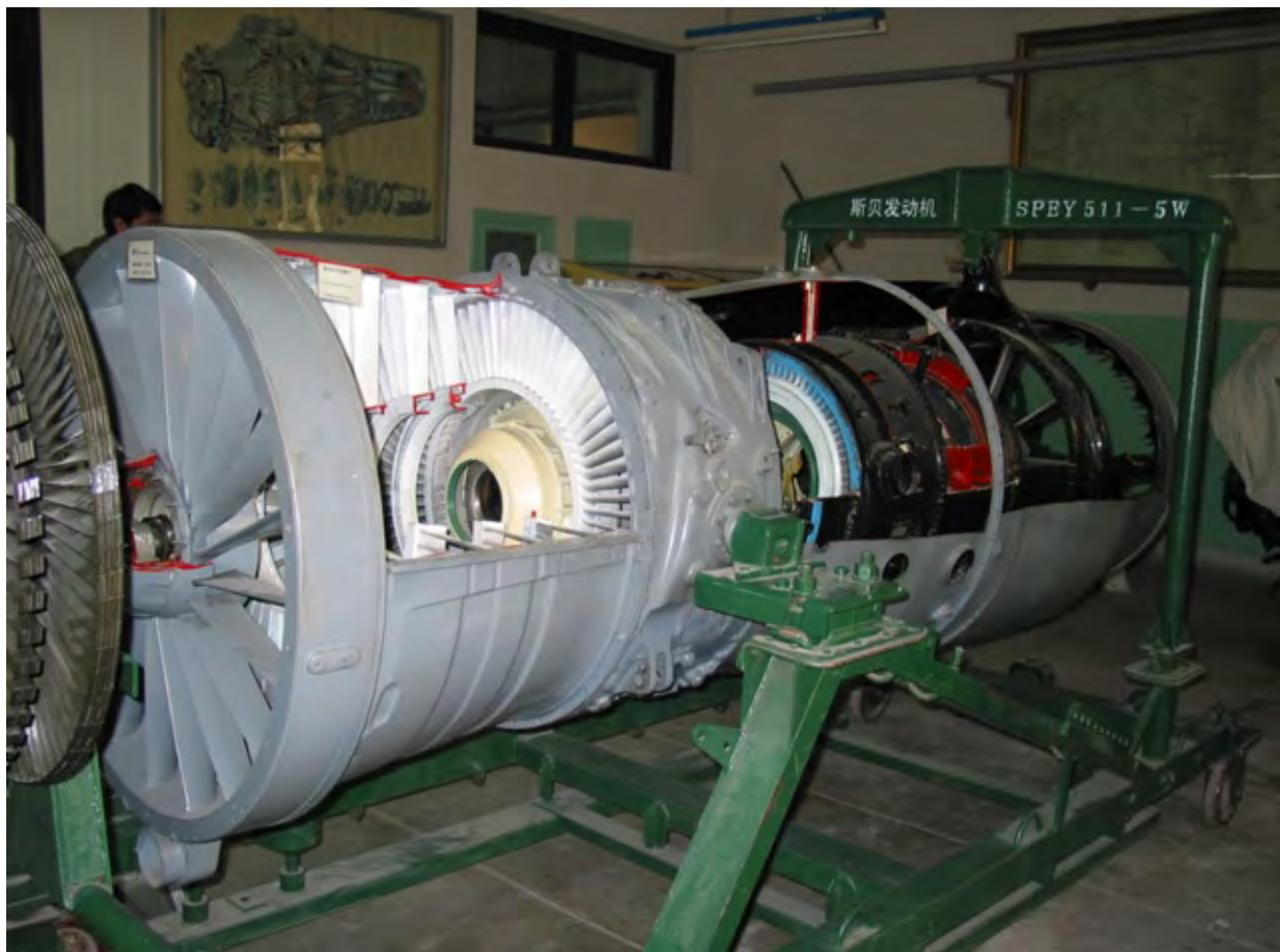
斯贝 MK511 发动机，它是斯贝 MK202 发动机的原型之一。
