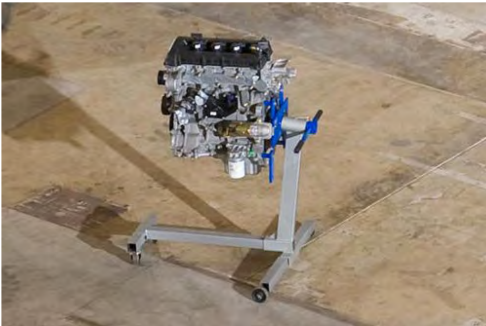
四缸氢气燃料发动机
