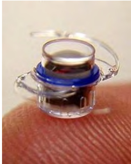
放在指尖的 VisionCare 可植入微型望远镜
