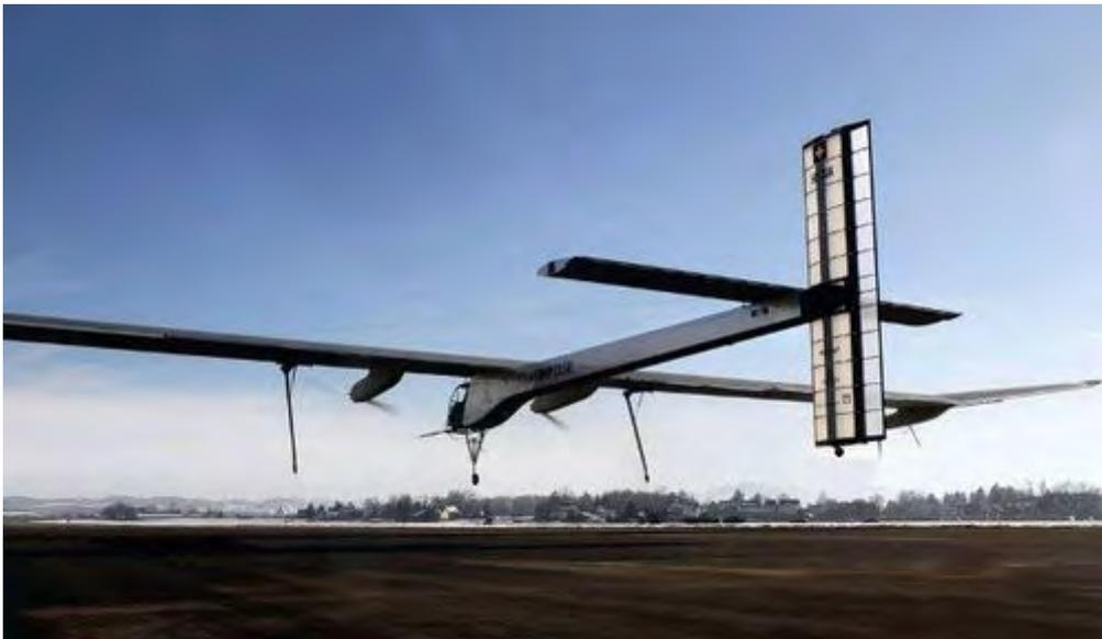
瑞士太阳能飞机“阳光动力”(Solar Impulse)样机
