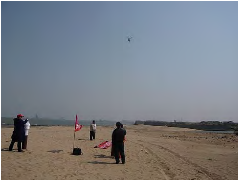
地空试验现场（地面模拟气体泄漏）
