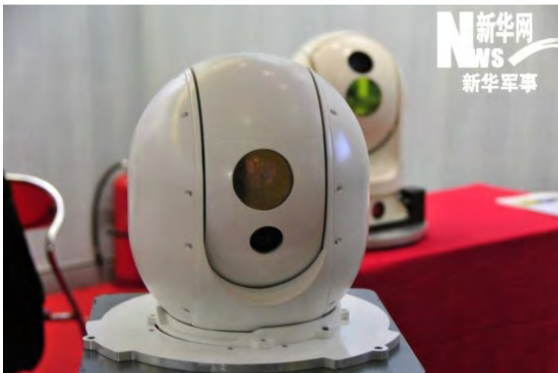
无人机用光电探测系统。新华军事记者郑文浩 摄
