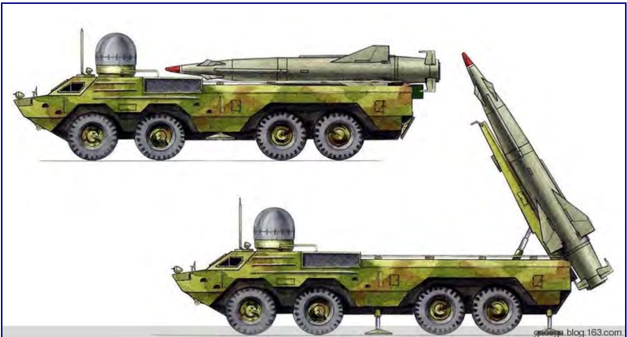
火炬设计局以 B611 为基础发展出了 B-614 远程机动地空导弹
