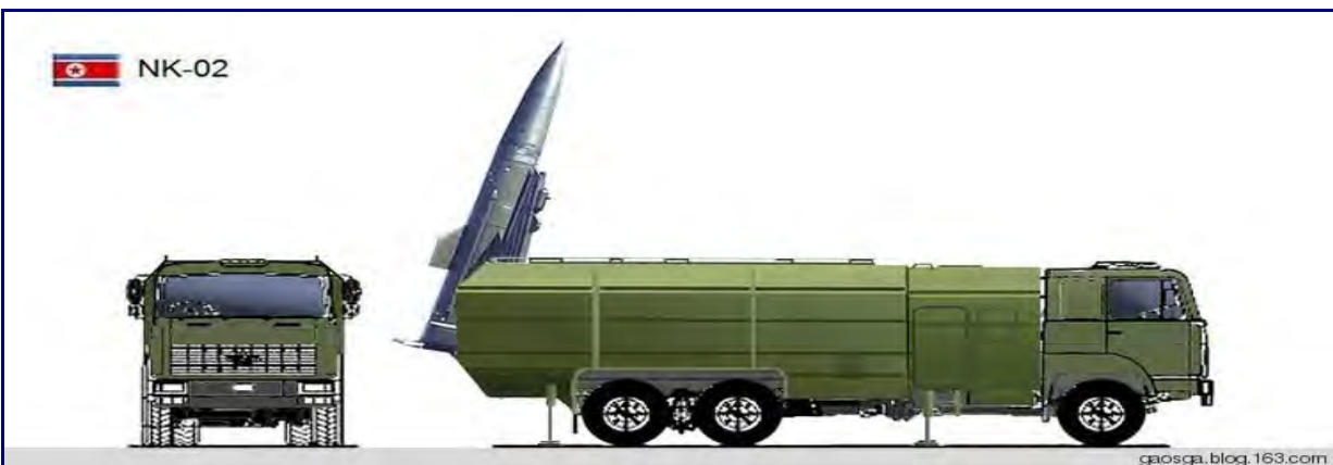
NK-02 弹道导弹使用俄制 MA3-63171 卡车作为底盘。
