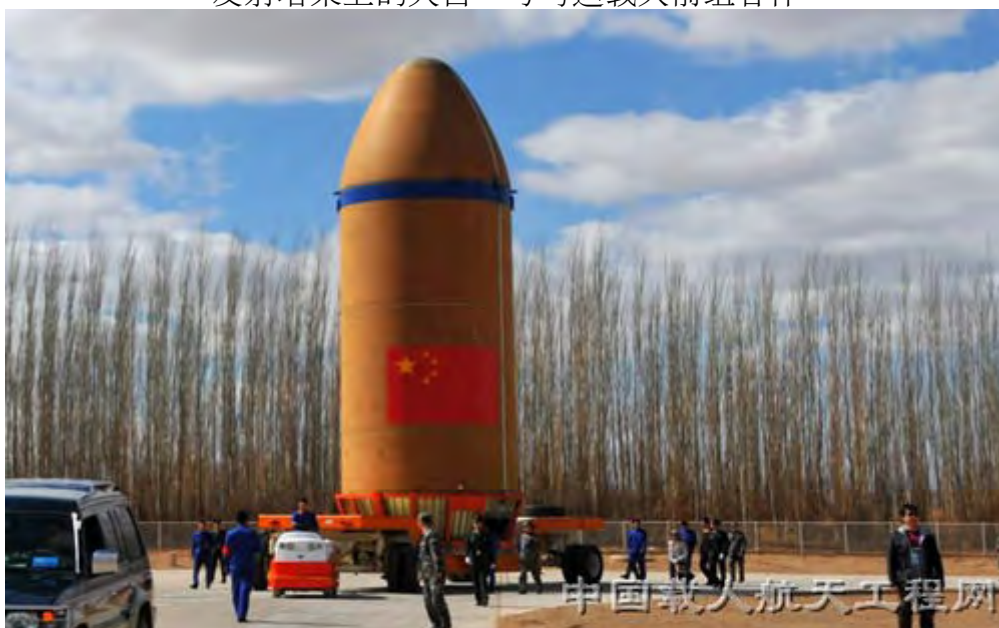
天宫一号器罩组合体转运至垂直总装厂房与火箭对接
