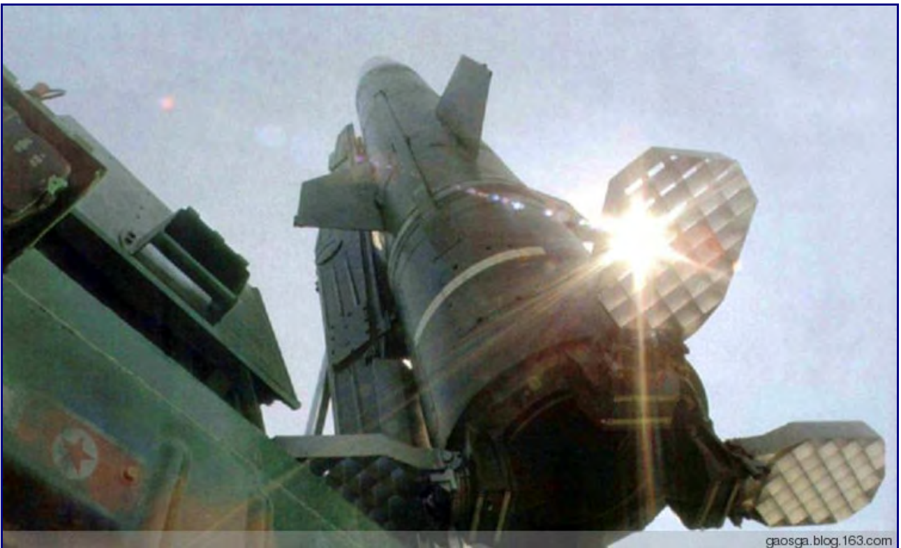
这可能是最早曝光的朝鲜 9K79 导弹图片，看车位左侧盖板的形状，应该是俄国原装的。
