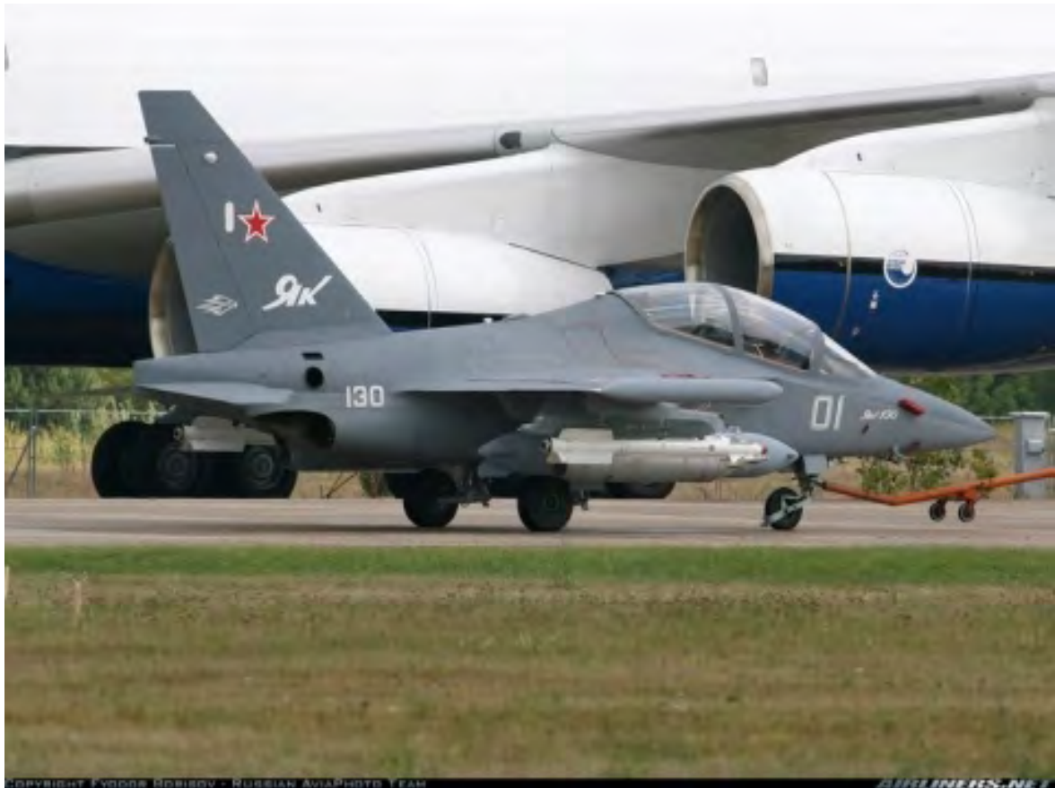
出于缩短尾喷管的考虑，喷管缩到“腋下”
