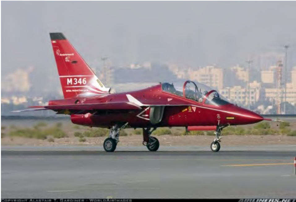
M-346 最大的特色是翼根的一对小翼，用于控制涡流的位置
