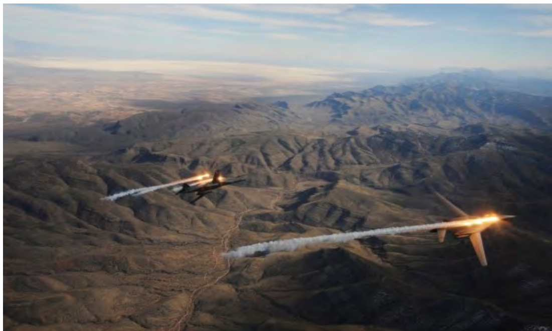
B-1B 轰炸机编队在新墨西哥上空进行训练演习布撒箔条和火焰弹
