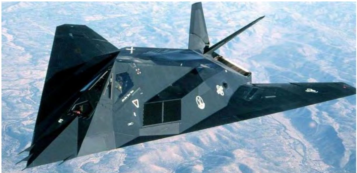
F117 战斗轰炸机采用了格栅进气道来屏蔽来射雷达波
