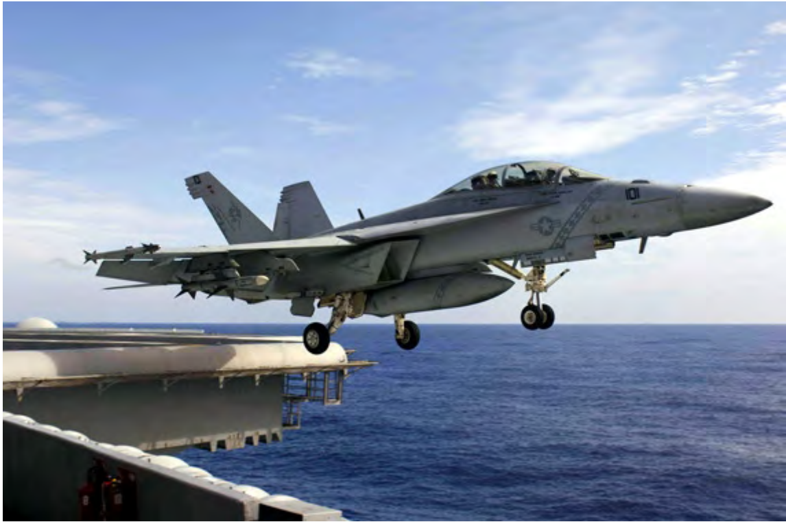
F/A-18E/F 采用了双斜切的进气道唇口，集中反射雷达波
