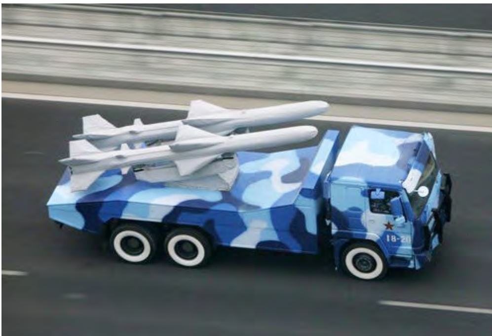
在 国庆阅兵式 上亮相的鹰击 83 舰用型，注意导弹尾部多了一个固体火箭助推器。
