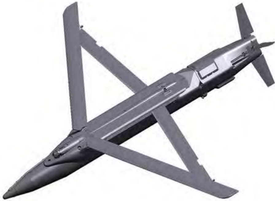
钻石背滑翔弹翼和尾部弹翼展开状态的 GBU-39
