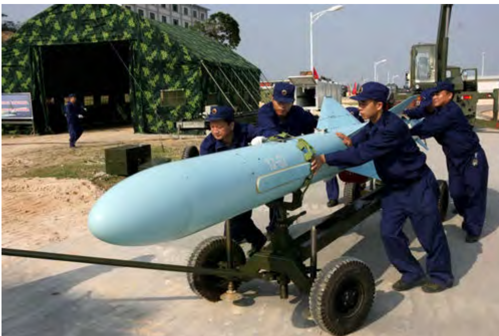
鹰击 83 反舰导弹已广泛装备部队，图为海军后勤官兵准备为舰艇填装鹰击 83。
