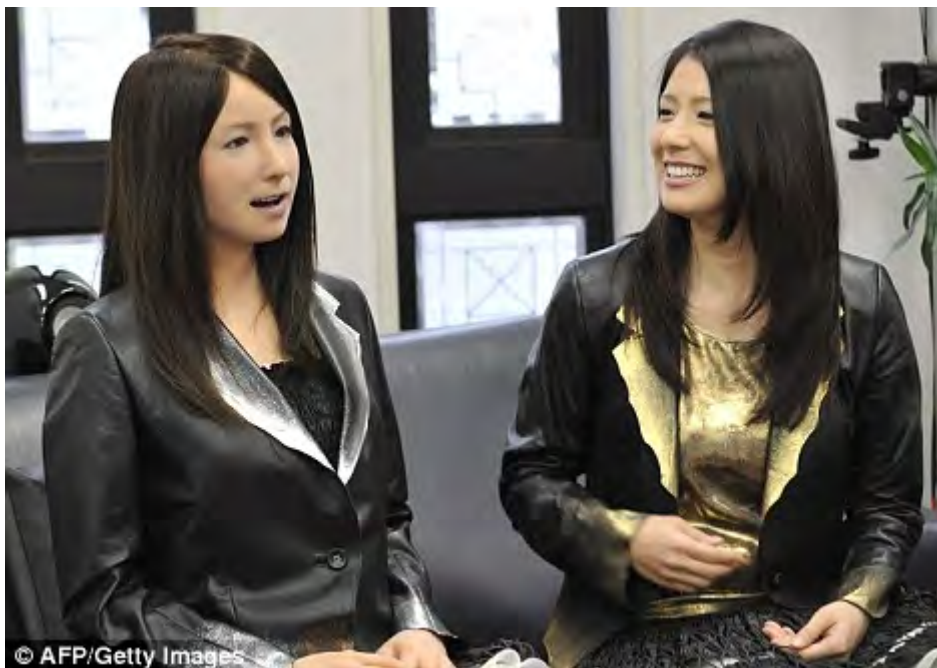
使用动作捕捉系统，Geminoid TMF 机器人的橡胶脸能变动模仿人类微笑，咧嘴大笑和皱眉
