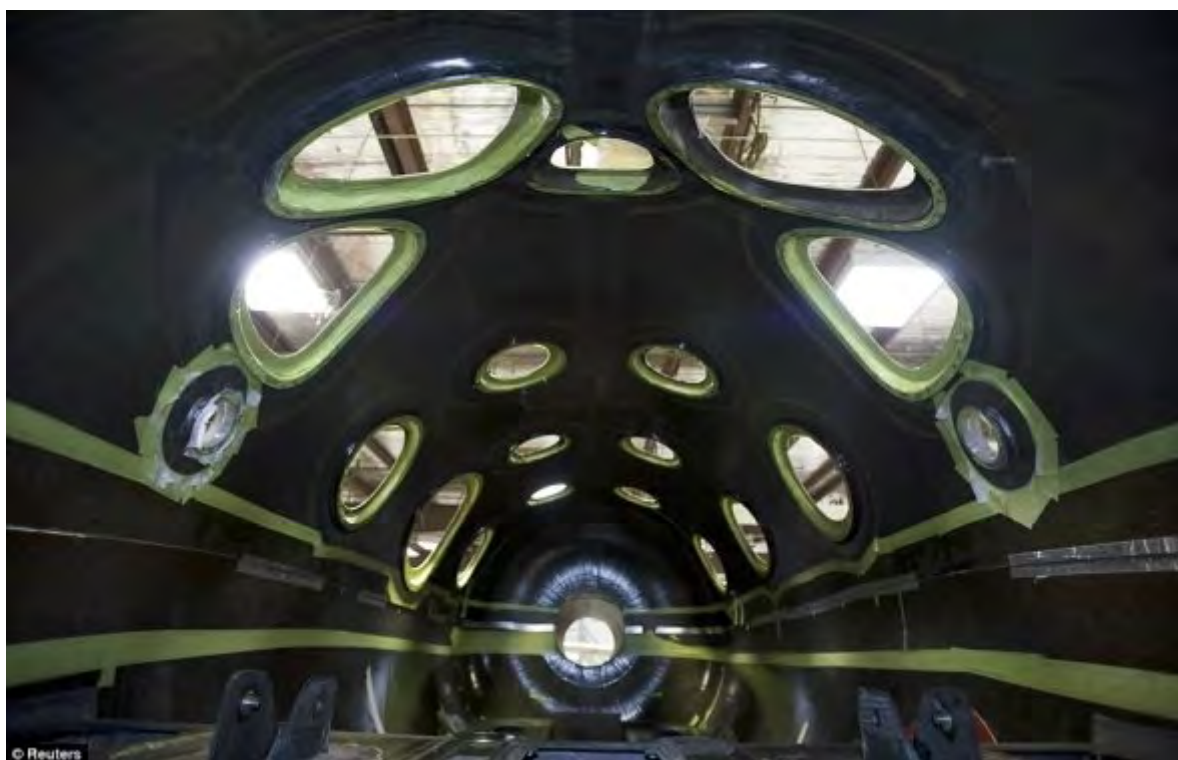
“太空船二号”建造期间机舱内部结构一瞥。
