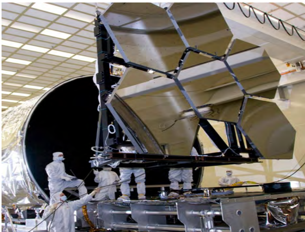
研究人员正在对詹姆斯·韦伯天文望远镜第一组镜片进行测试。
