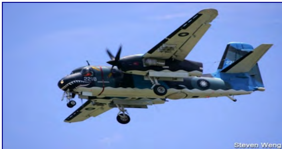
台湾 S-2T 反潜/巡逻机，注意机腹圆形的雷达天线
