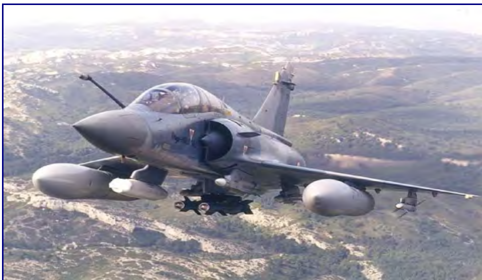
幻影-2000 的机腹双联装激光制导炸弹挂架
