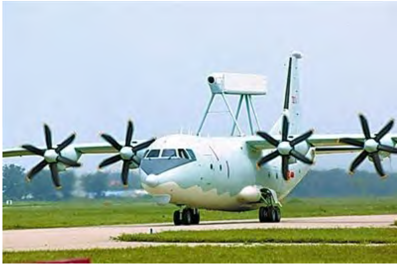
采用平衡木有源相控阵雷达设计方案的空警 200 预警机
