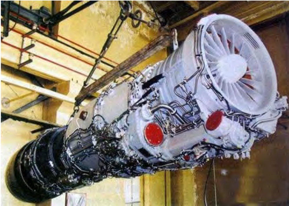
资料图：国产秦岭涡轮风扇发动机仿制自英国斯贝发动机，主要用于装备飞豹战机。
