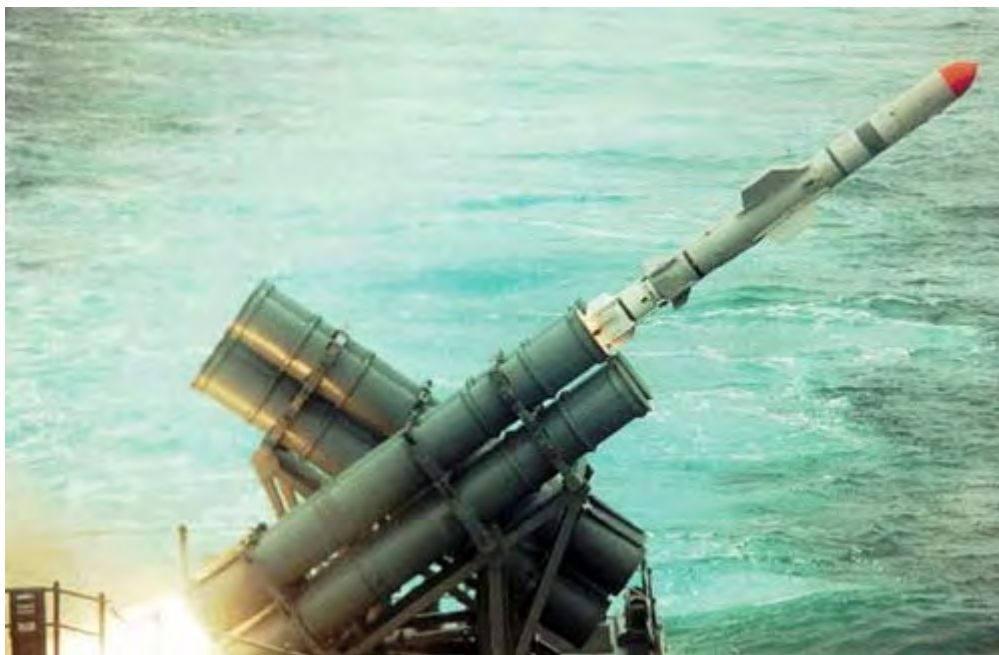
美国海军中最常见的“鱼叉”发射方式——四联装发射筒
