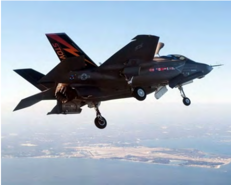
F-35B 采用升力风扇和主发动机推力转向相结合，产生垂直升力
