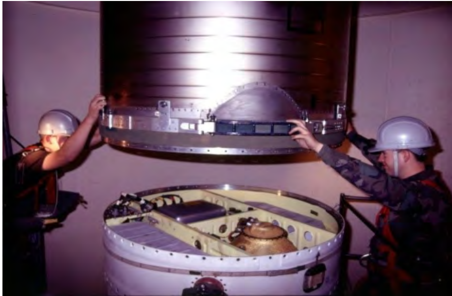
下面是制导舱，上面是包裹在整流罩中的释放舱及弹头
