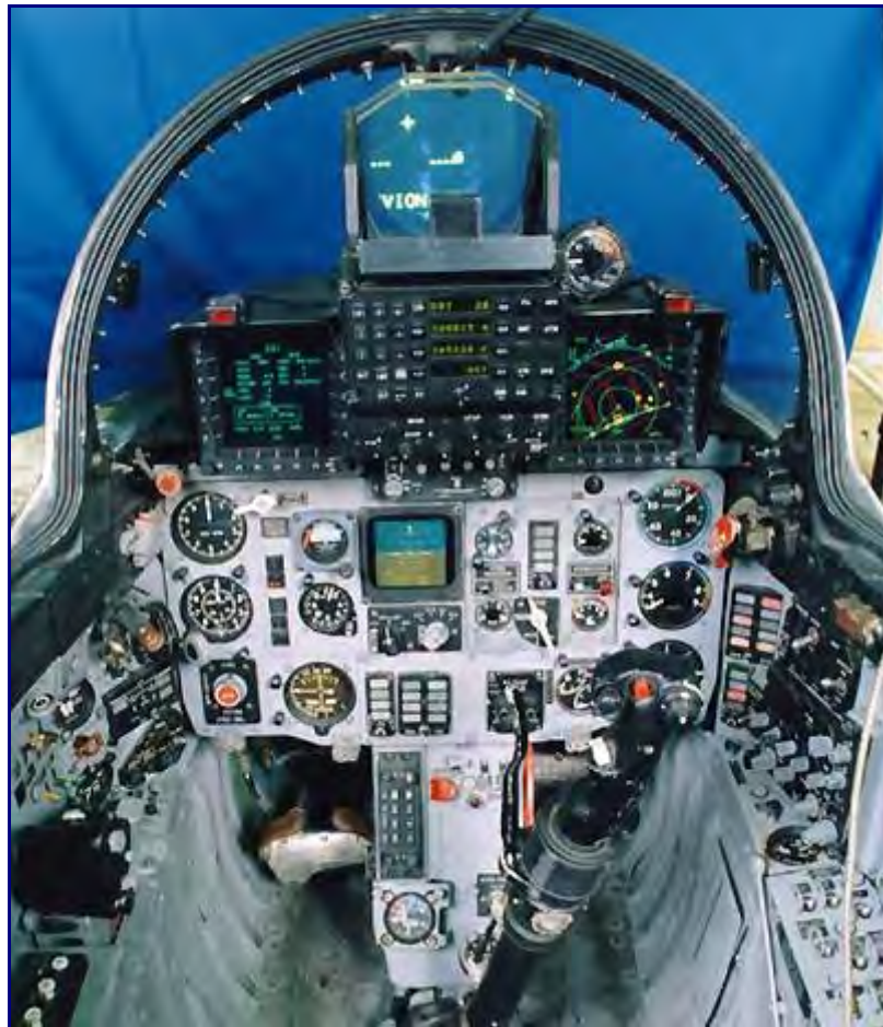
米格-21-2000 换装了一平两下的玻璃化座舱
