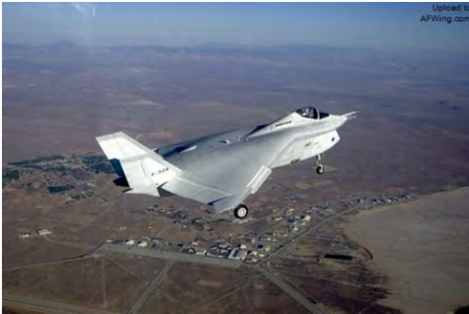
波音 JSF 采用无尾三角翼
