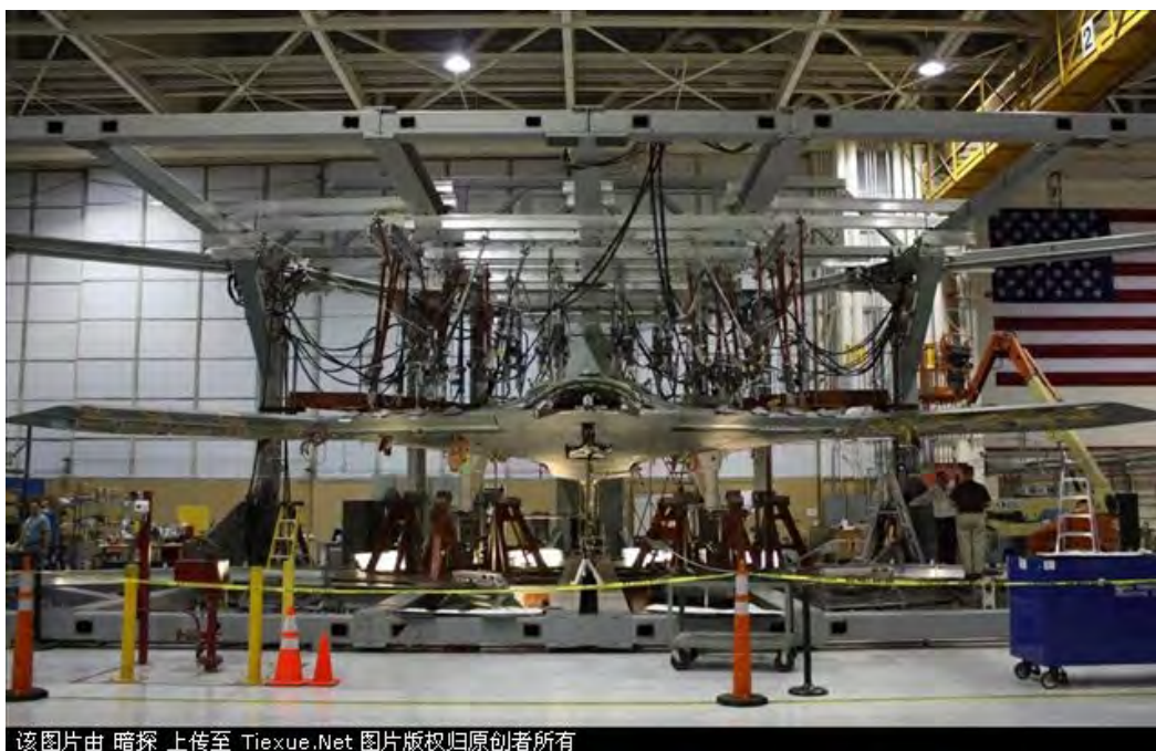
另外一架 X-47B 在厂房里进行静力加载试验
