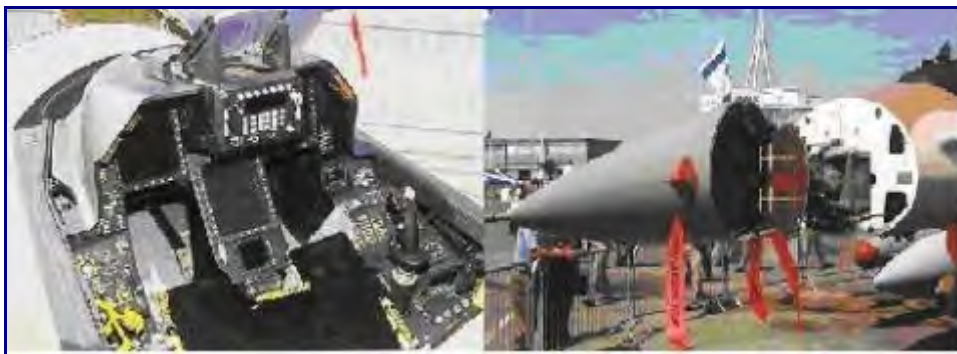
F-16ACE 的全玻璃化座舱和 EL/M-2032 雷达，注意天线有敌我识别天线
