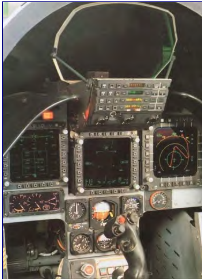
LAVI 的全玻璃化座舱，突出显现以色列在航空电子领域的水平
