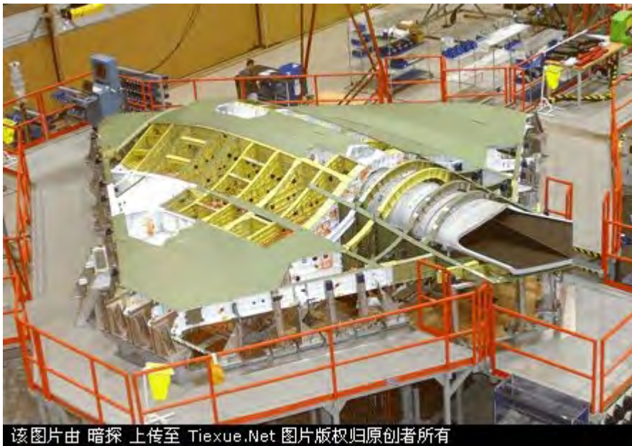
装配线上的 X-47B 机翼还没有安装完成，经过红外弱化处理的发动机尾喷口清晰可见
