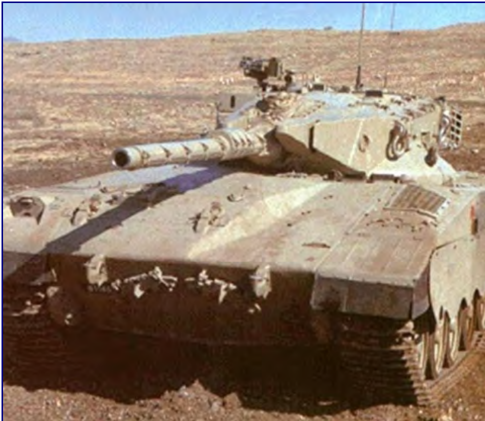
梅卡瓦 MK1 使用的 M68 型 105 毫米线膛炮，注意热护套
