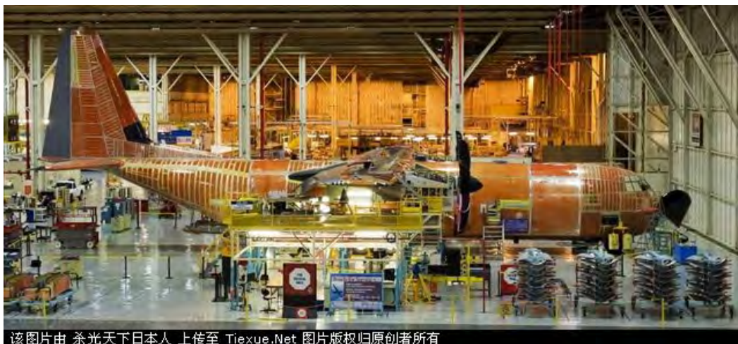
2009年11月5日，加拿大空军CC-130J 1号机安装完主翼和引擎后。
