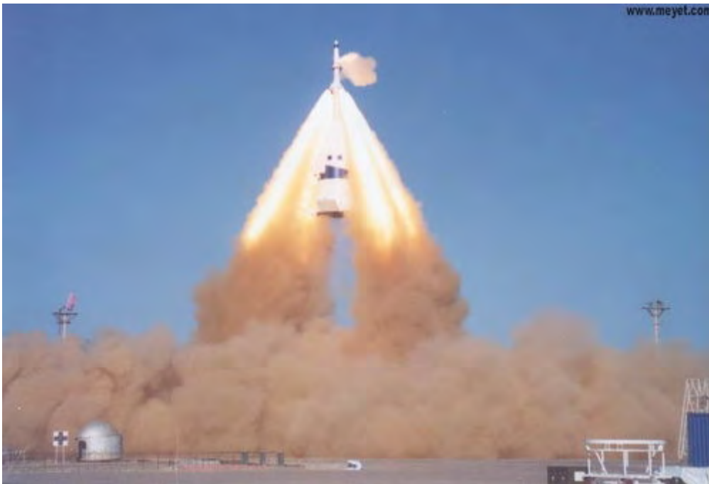
火箭牵引式逃生系统现在常用在载人航天器上，图为“神舟”飞船逃生试验
