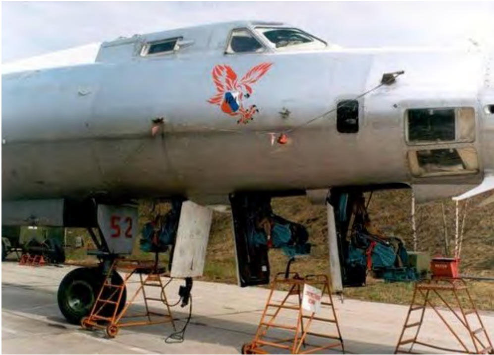
图-22 的弹射救生机构，机组成员是向下弹射的。
