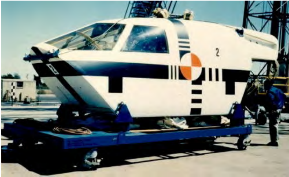
B-1A 的整体式逃生系统做得更彻底，将整个座舱“连根拔”
