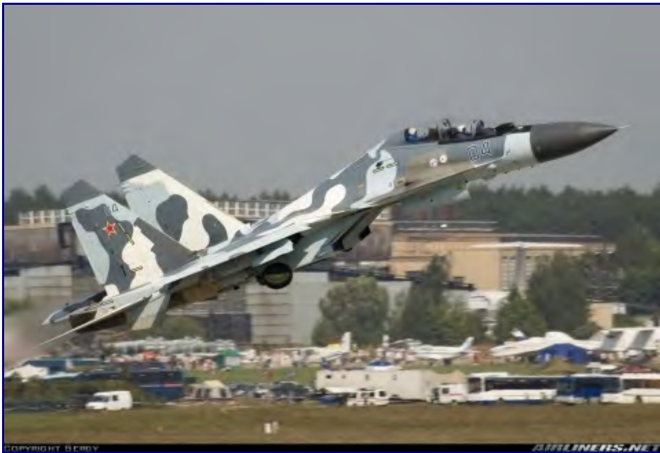
苏-30MKM 的鸭翼和机翼位置太近，很难充分发挥出鸭翼的作用
