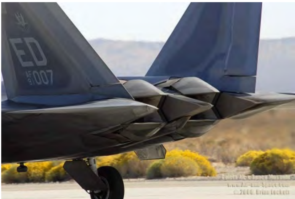
F-22 的 F119 发动机采用二元喷口，除了可以上下偏转以实现推力转向，喷流可以压扁，强化和环境空气的混合，迅速降温，降低红外特征
