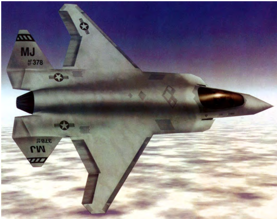
麦道 JSF 的机翼相当于锯齿形后缘的大三角翼
