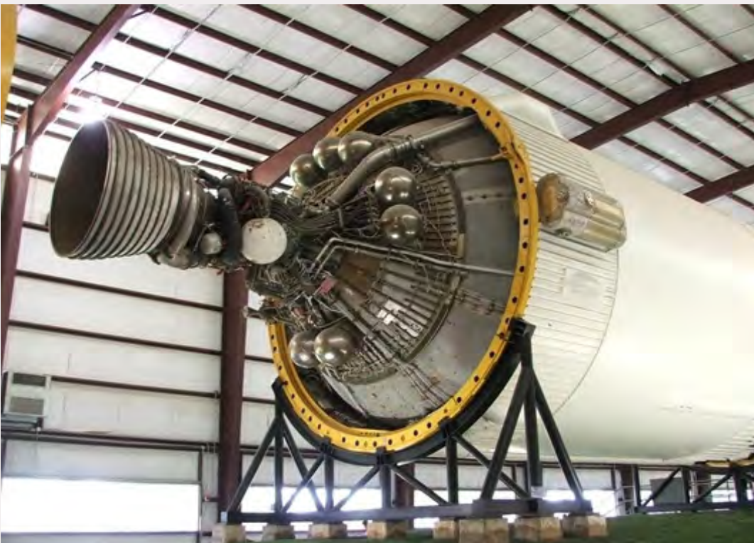
第三级火箭，有一个发动机。发动机型号与第二级火箭所用发动机相同
