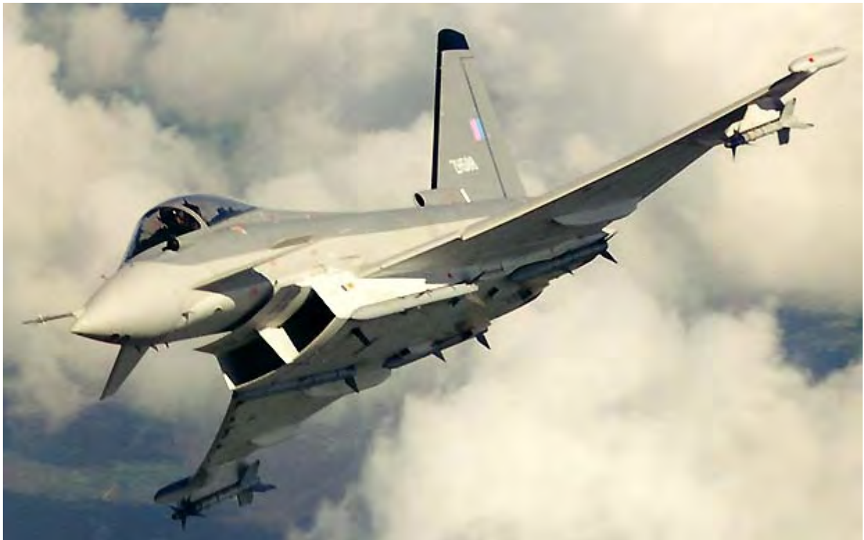
欧洲“台风”那样的机腹进气口不大适合于机内武器舱的布置
