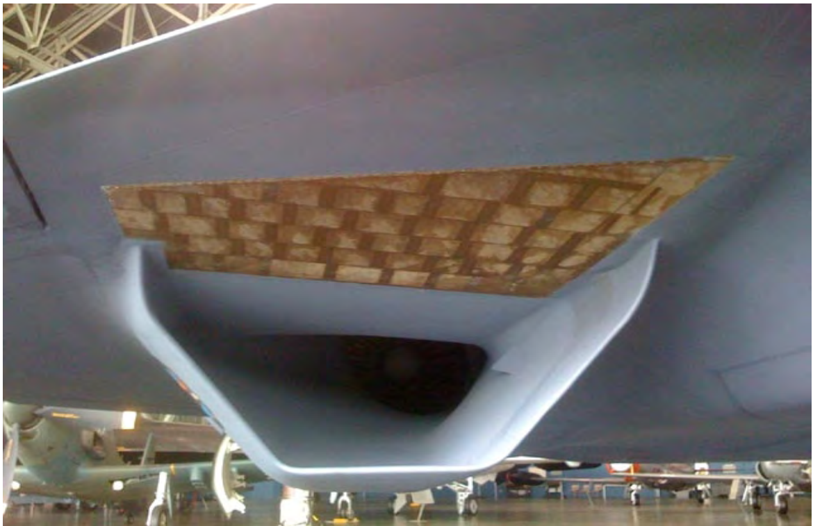
YF-23 的吸气式边界层分离技术上比较特别的，隐身效果最好
