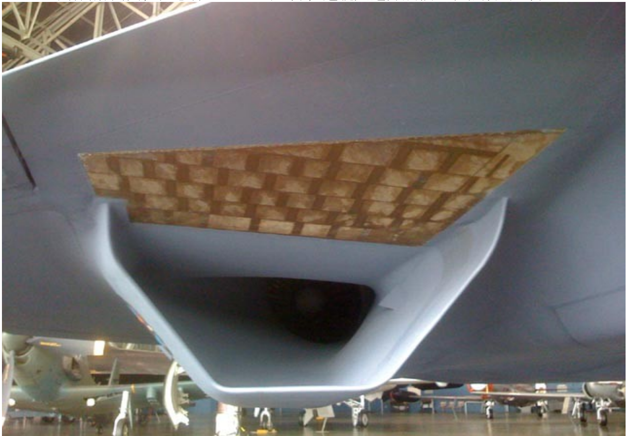
进气口前浅黄色网格的地方就是边界层吸收装置，现在为了封存而盖没了。从正面看，进
