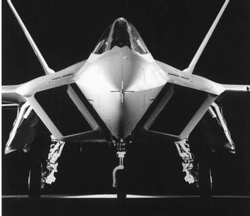
F-22 的 Caret 进气口和机身之间有明显的空隙，这就是分离边界层的地方
