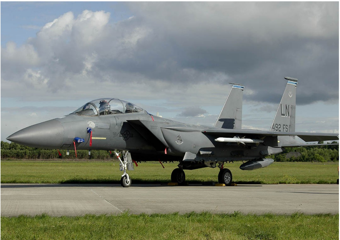
F-15 的楔形进气口有利于大迎角飞行时发动机的稳定进气
