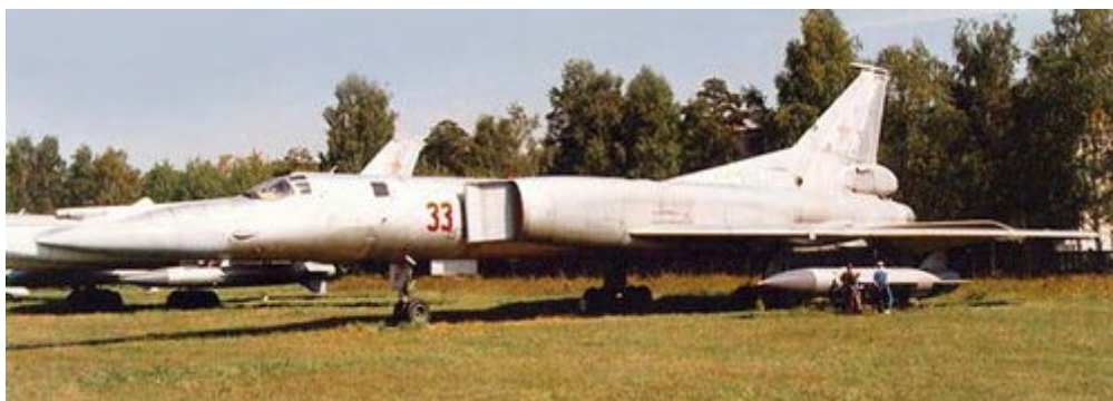
图-22M 早期型号，注意进气道形状和现役型号的区别
