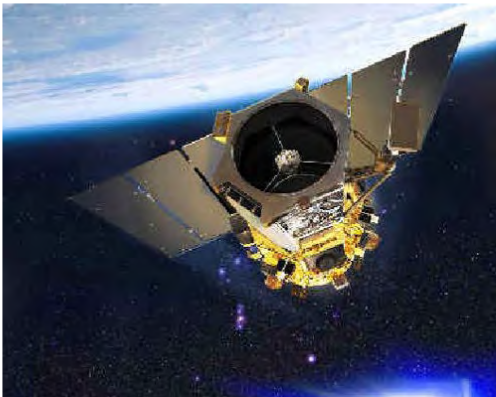
GeoEye-1 商业成像卫星的成像精度已达 0.5 米
