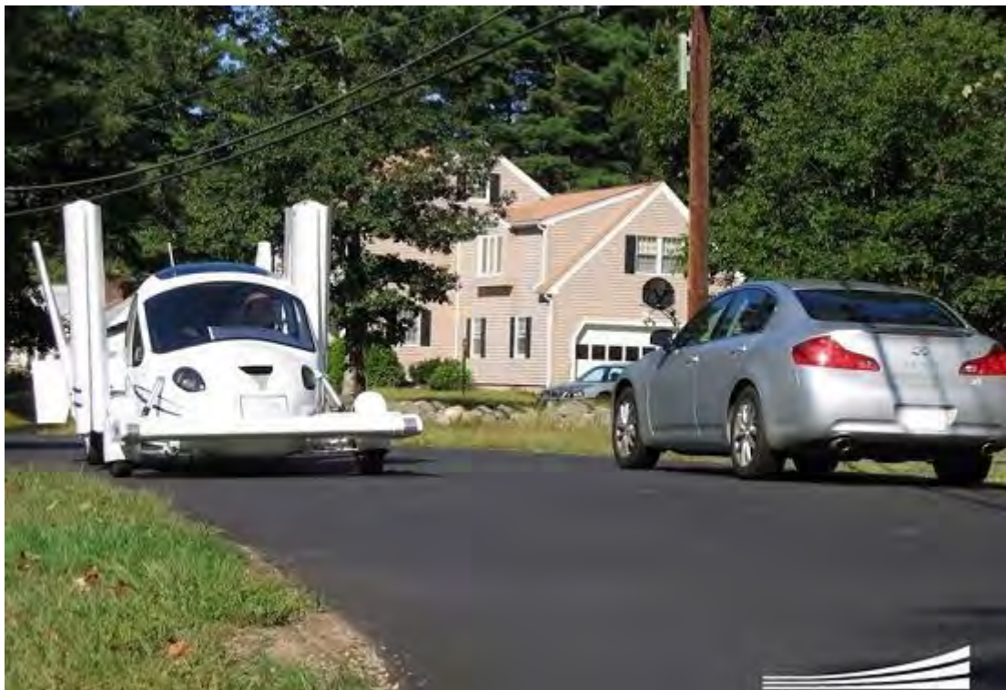
图 20: “变形者” 的前轮可以使它在地面上顺利行驶
