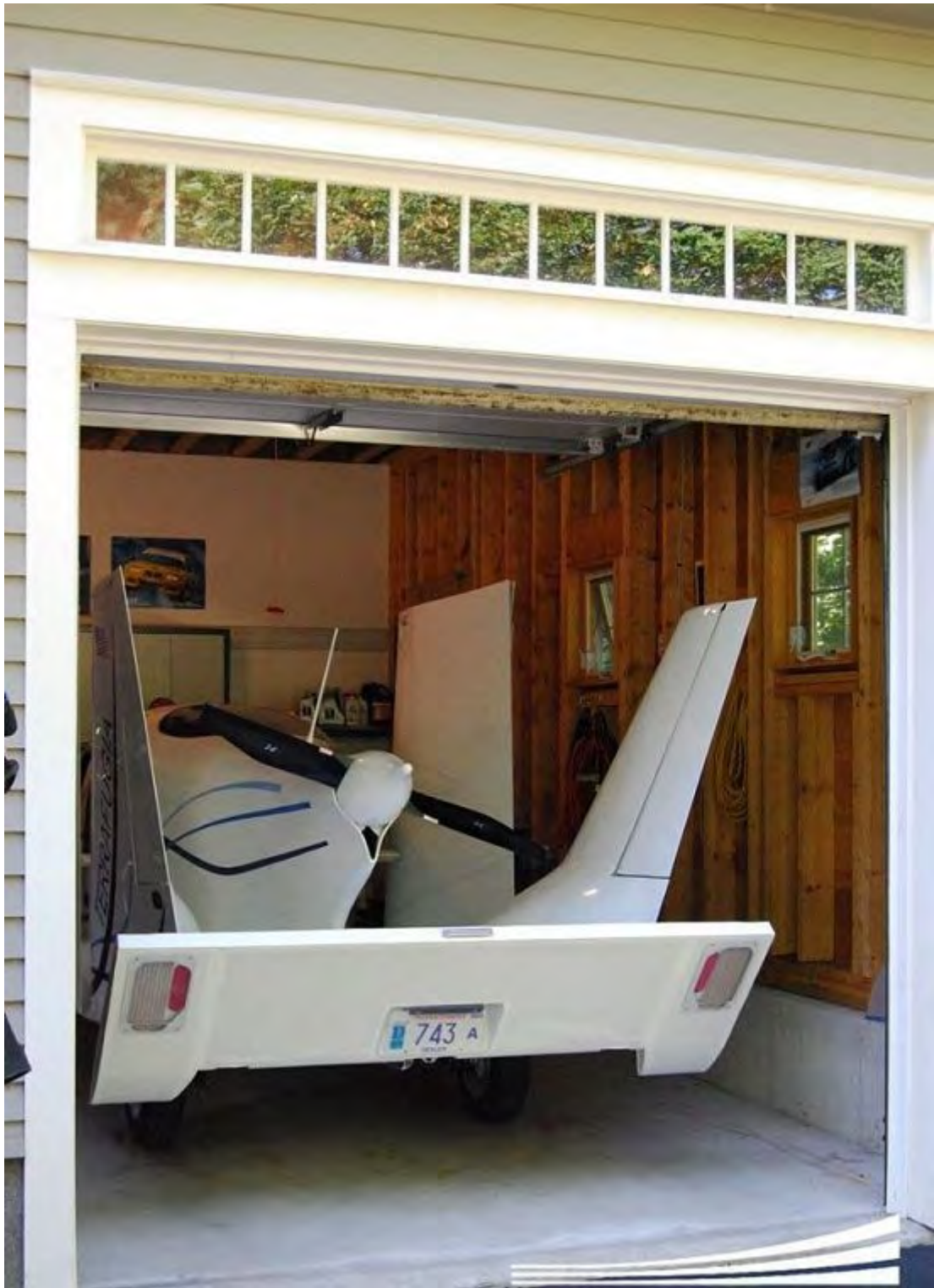
图 23: “变形者”只有6英尺9英寸高，80英寸宽，机翼可折叠
