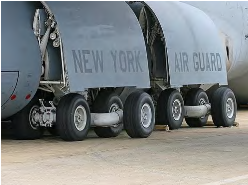
可降低的起落架为装卸重型车辆创造了极大的便利
