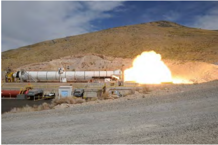
点火试验总共持续 123 秒，火箭发动机喷出了强烈的火焰
