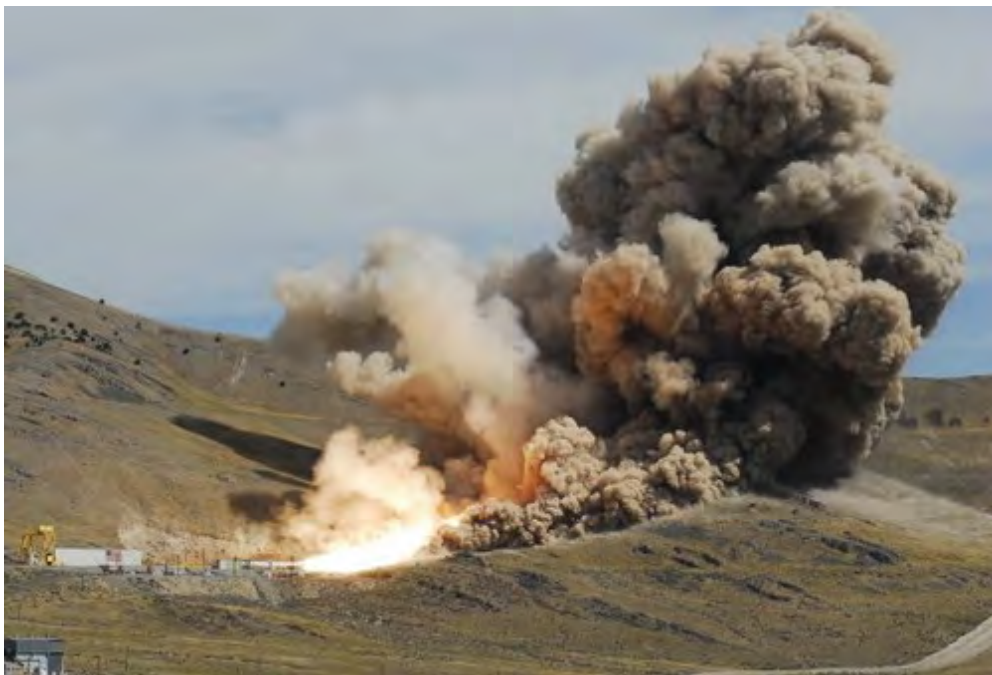
测试期间，650 个数据通道被用于收集发动机性能的有关数据
