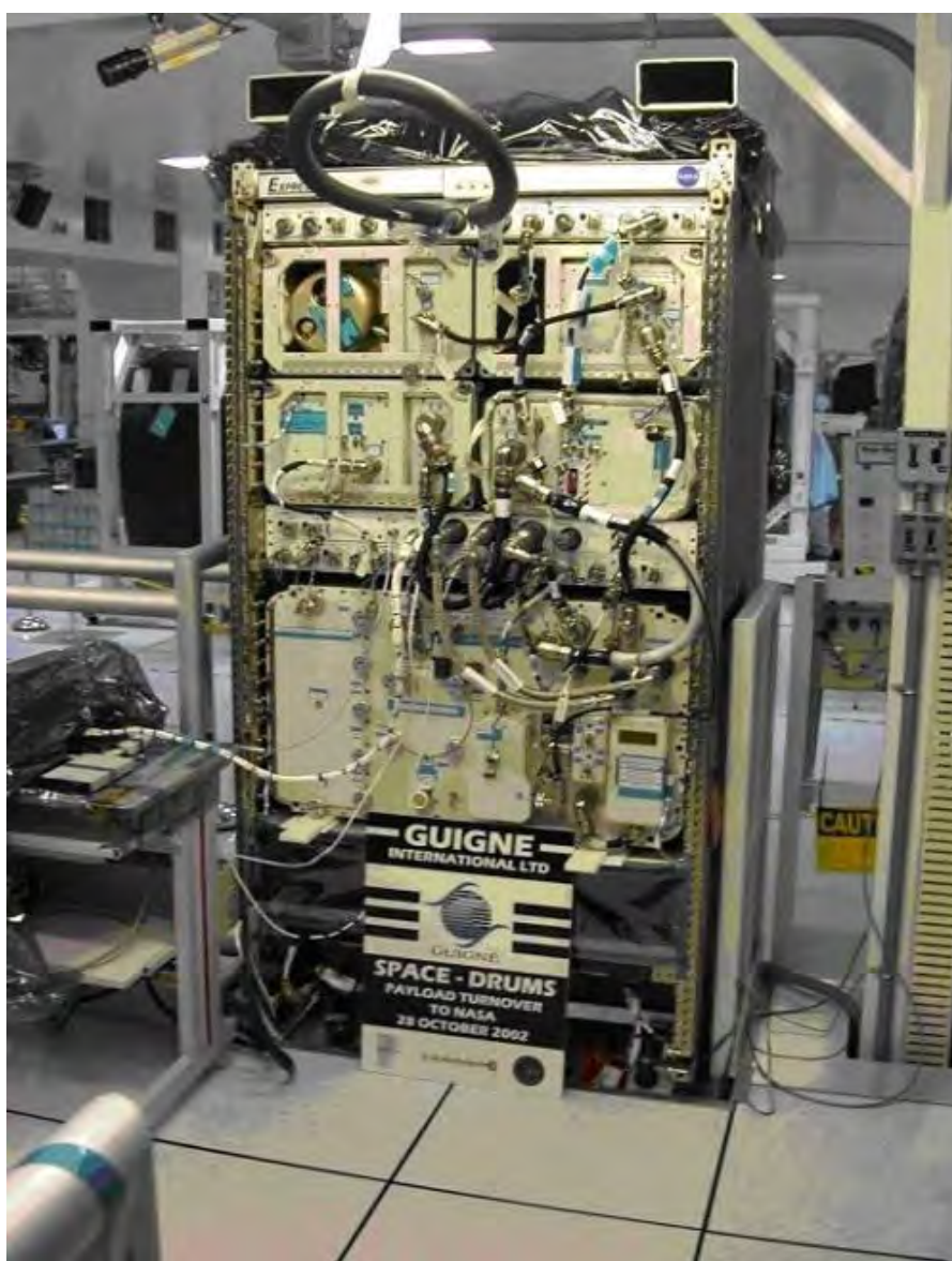
图 太空鼓传输架 空间鼓系统将通过这样的传输架送到国际空间站。
