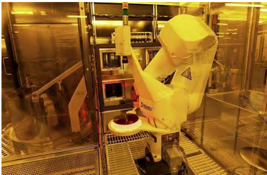
图：2009年6月16日，德克萨斯州电器公司的半导体组装车间的超净室中，一根机械臂正在操作硅晶片的生产。
