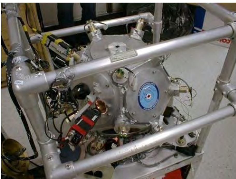
图：太空鼓正在工作 空间鼓正式工作的时候，除了连接有 20 个声波传导器，还有 3 个照相机实时监控反应状态。
