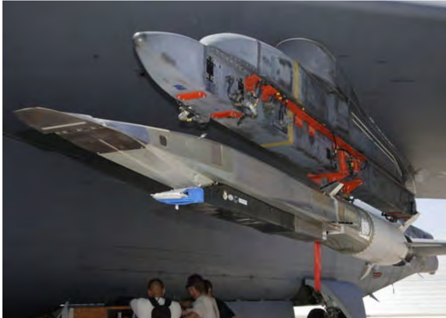
加挂在 B-52H 机翼的 X-51A
