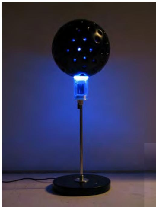
被诱捕的昆虫最终会跌落进微生物燃料电池。产生的电能可以供紫外线LED照明用，当室内电灯关闭时，紫外线LED开启能够诱捕更多的苍蝇。
