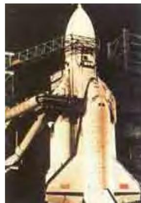
科学家们认为，这次完全靠地面控制中心遥控机上电脑系统，在无人驾驶的条件下自动返航并准确降落在狭长跑道上，其难度要比1981年美国航天飞机有人驾驶试飞大得多。首先，暴风雪号的主发动机不是装在航天飞机尾部，而是装在能源号火箭上。这样就大大减轻了航天飞机的入轨重量，同时腾出位置安装小型机动飞行发动机和减速制动伞。其次，暴风雪号着陆时，可用尾部的小型发动机做有动力的机动飞行，安全准确地降落在狭长跑道上，万一着陆姿态不佳，还可以将航天飞机升起来进行第二次着陆，从而提高了可靠性。而美国航天飞机靠无动力滑翔着陆只能一次成功。第三，暴风雪号能像普通飞机那样借助副翼、操纵舵和空气制动器来控制在大气层内滑行，还准备有减速制动伞，在降落滑跑过程中当速度减慢到50公里/小时自动弹出，使航天飞机在较短距离内停下来。暴风雪号首航成功，按计划应很快开始载人飞行，但由于政治、经济等方面的原因，该计划现已基本停止了。
