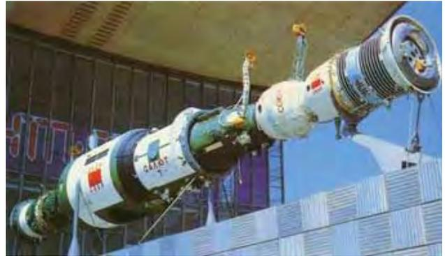
前五座礼炮号空间站只有一个对接口，只能与一艘飞船对接飞行。因站上携带的食品、氧、燃料等储备有限，空间站的飞行寿命都不长。经过改进的礼炮 6 号和 7 号空间站，增加了一个对接口，除接待联盟号载人飞船外，还可与进步号货运飞船对接，用以补给各种生活必需品。礼炮 6 号空间站在太空飞行近五年，共接待 18 艘联盟号和联盟 T 号载人飞船。有 16 批 33 名字航员到站上工作，累计载人飞行 176 天。其中 1980 年宇航员波波夫和柳明创造了在空间站飞行 185 天的纪录。礼炮 7 号空间站进入轨道飞行之后，接待了联盟 T 号飞船的 11 批 28 名字航员，其中包括第一位进行太空行走的女宇航员萨维茨卡娅。1984 年，宇航员基齐姆维约夫和阿季科夫在空间站创造了 237 天的飞行纪录。礼炮 7 号空间站载人飞行累计达 800 多天，直到 1986 年 8 月才停止载人飞行。
