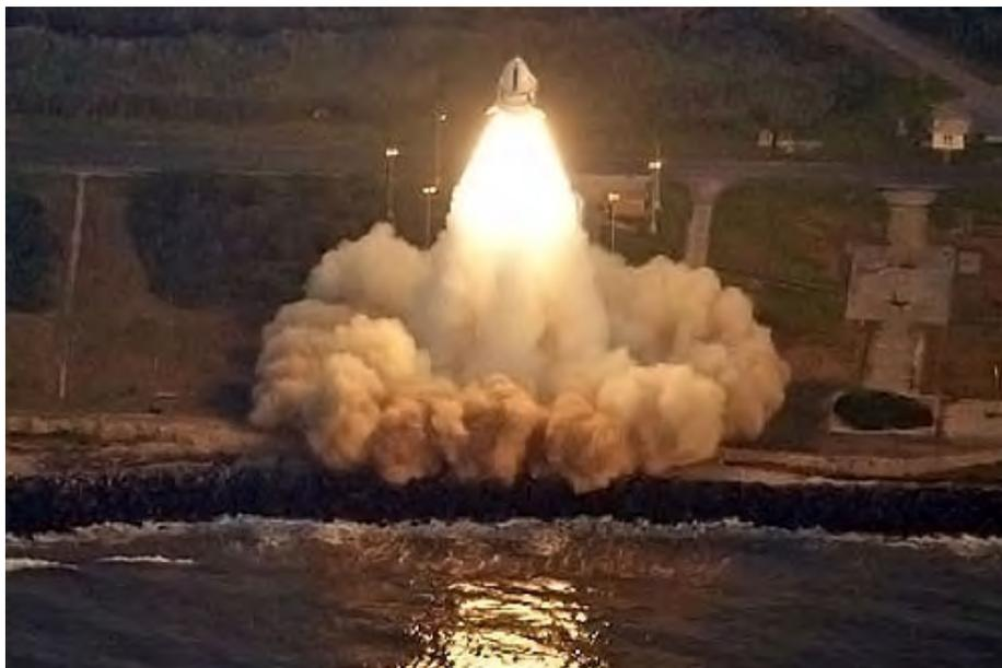
这个代号为马克斯异常中断飞行系统(Max Launch Abort System, 简称MLAS)的测试, 将帮助宇航员在发射台及入轨阶段成功脱离危险。该系统可作为 NASA “猎户座” 乘员运载器的异常中断系统的可选方案。
