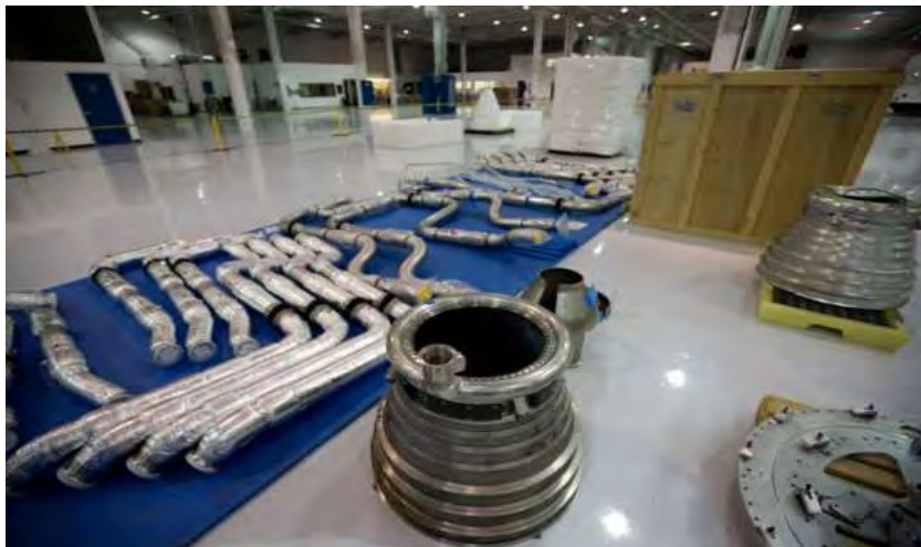
高压集合管和火箭顶锥部
