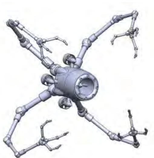
具有新型触觉系统的章鱼水下机器人
