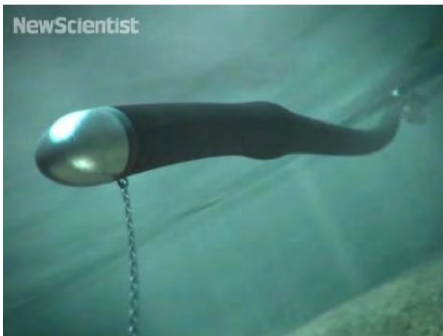
这种发电装置像一条海蛇，可以将海浪能转换为电能
