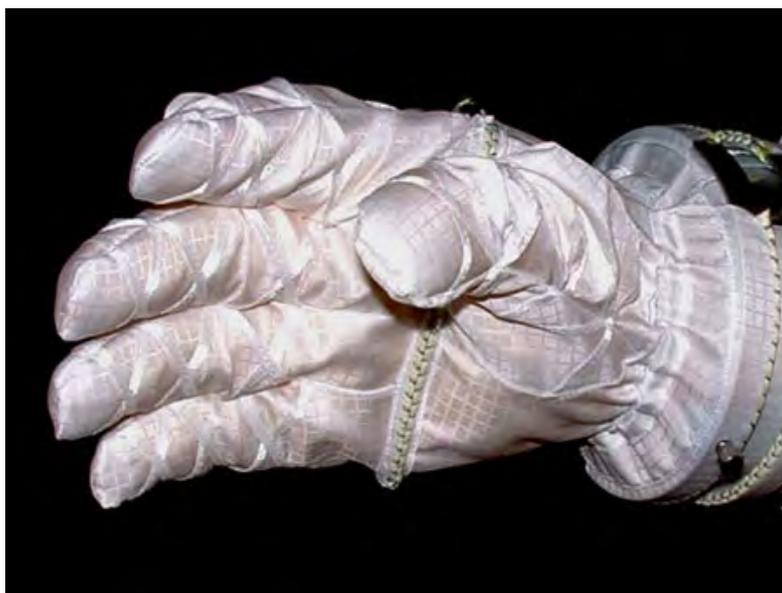
2007年5月，美国缅因州西南海港的工程师彼得·霍默在餐桌上缝制而成的太空人手套赢得了美国宇航局的“百年纪念挑战”大赛太空人手套挑战项目比赛的冠军，击败了专业组，获得了20万美元的巨额奖金。霍默表示，他的设计不像现行的手套起皱导致宇航员的手指像香蕉似的弯曲，迫使宇航员每伸缩一下手指都必须克服很大的阻力，而他的手套在手指的每一个关节都能弯曲，从而使宇航员更容易活动手指。
