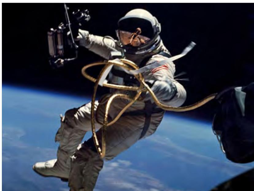
双子座航天服于1965年6月3日经受严峻考验，当时宇航员艾德·怀特乘坐双子座(Gemini)飞船到达太空，上演了美国历史上第一次太空行走，他太空行走的时间是23分钟。当爱德华·怀特打开双子座4号飞行器舱门，成为第一个走进太空真空的美国人时，他的航天服还通过一条8米长“脐带”和舱内相连。这条“脐带”连接着航天服胸部的压力调节和通风装置，提供氧气。与此同时，他使用气体动力枪来帮助他实行太空行走。
