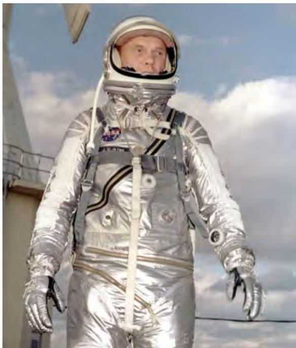
美国宇航局约翰·格伦于 1962 年成为美国第一个围绕地球轨道飞行的宇航员，格伦也是惟一穿上水星航天服和航天飞机航天服在太空飞行过的宇航员。在此图中他身穿美国宇航局的首款航天服——水星航天服。此航天服是由美国空军进行高空飞行的压力服改进来的，原本没打算让宇航员穿着它进行太空行走，仅在太空舱失去压力的紧急情况下作为急救保护。
