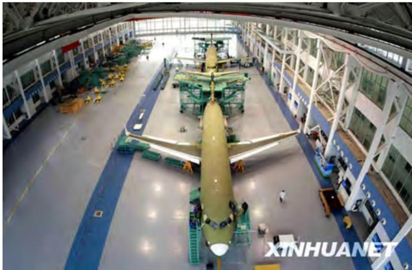
2009年3月5日，在上海飞机制造厂，两架ARJ21新支线飞机在总装车间同时进行总装。ARJ21系列飞机是我国第一个外销欧美发达国家的飞机产品，目前国内外订单为208架。其中，美国最大飞机租赁公司通用电气金融航空服务有限公司（GECAS）订购了25架。新华社发
