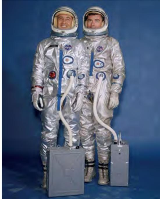
在设计双人双子座飞船使用的航天服时，工程师们借鉴了美国空军的做法。关节处不再用纤维连接，而改用充气的压力气囊和内部网状衬里来维持一定的压力，并使航天服在加压状态下也能保持相对灵活。美国宇航员格斯·格里逊(左)和约翰·杨于1965年3月进行了首次双子座飞船飞行任务，围绕地球轨道飞行了5小时。从图片中我们可以看到，他们所穿的航天服连着一个便携式空调，来保持航天服的凉爽。
