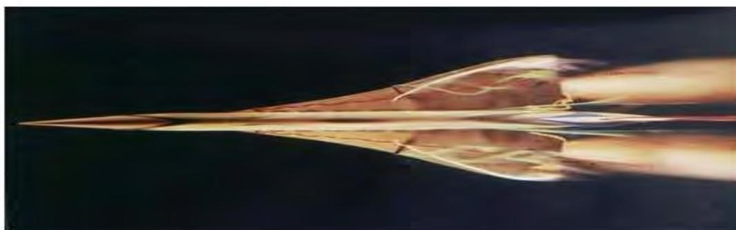
协和飞机模型的风洞实验
