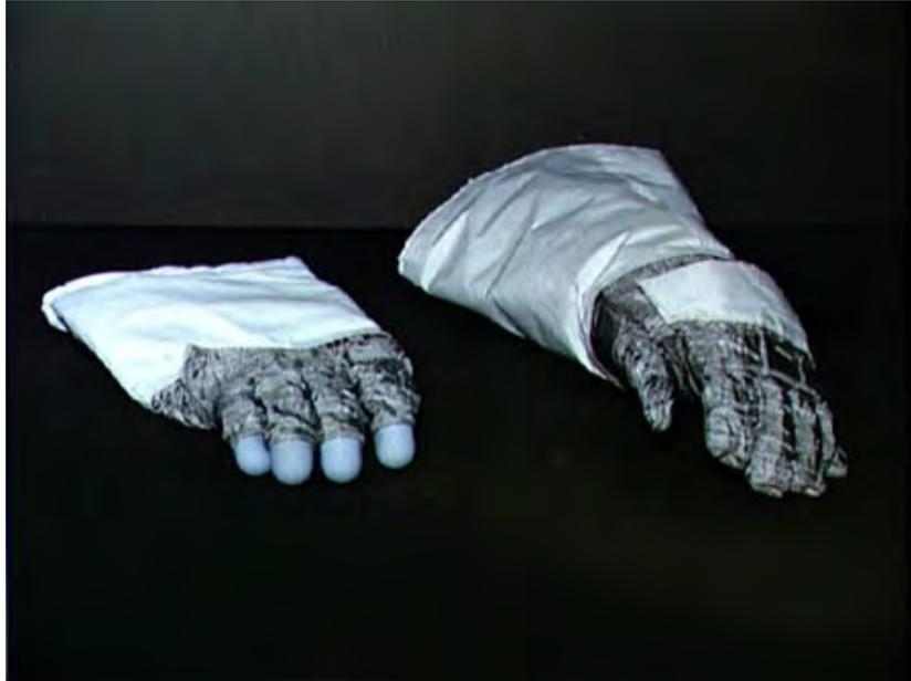
对于宇航员来说，航天手套可能是航天服中最重要部件。航天手套被加压，因此对宇航员来说很难活动他们的手指。此外，此手套设计还必须确保能操作精密仪器。阿波罗飞船的宇航员在月球配备有双层手套，内层(左)具有由根据宇航员手模型制作的压力气囊，外层覆盖多层迈拉品牌的超绝缘材料、布料和金属网状物，以隔离热量，承受摩擦。大拇指和手指尖部位采用硅橡胶材料，保证一定程度的灵敏“触觉”。像头盔一样，手套通过压力封闭环和衣服连接。此外层手套用于太空行走中以保护他们不受微小陨石击伤、刮伤和烫伤。
