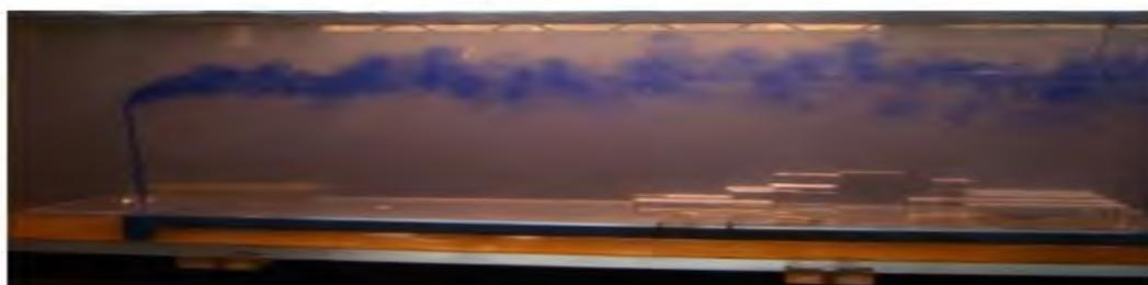
天津大学流体力学实验室用流动显示进行小区环境评估的实验
