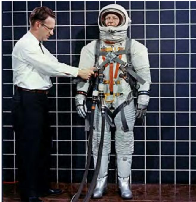
在距离地球25万英里外的月球表面漫步为航天服设计师提出了新挑战。月球探索者的衣服不但必须考虑月球表面粗糙崎岖的岩石、白天的高温，还必须足够灵活。为了更好的灵活性，在阿波罗航天服肩膀、肘、髋关节和膝盖处采用波纹管式的橡胶垫。此图片是1968年进行阿波罗航天服的测试中，美国工程师比尔·彼得森让飞行员鲍比·史密斯穿上阿波罗航天服进行测试，给此航天服装上一条月球远行舱束缚带，将宇航员和登月舱连接起来。
