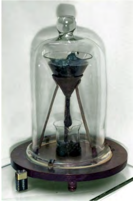
每一滴沥青需历经大约 10 年时间才能滴入漏斗下方的烧杯
