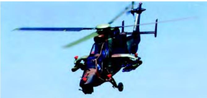
“虎”式直升机左侧短翼下挂了4发“海尔法”导弹
