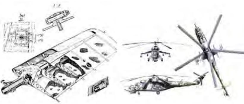
左图为米-24 短翼结构图。右图为米-24V 三视图
