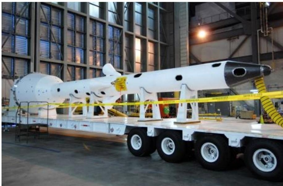
2009年1月31日，战神1号试验火箭发射逃逸系统(launch abort system)运抵佛罗里达州美宇航局肯尼迪航天中心飞行器装配大楼。发射逃逸系统在战神火箭的最顶端，一旦发生运载火箭失灵事故，这套系统将为宇航员提供安全撤离。
