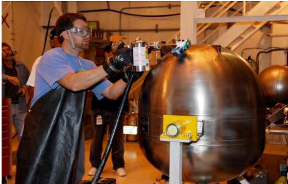
美宇航局肯尼迪航天中心一处自燃维护设施内，一名技术人员在测试战神1号试验火箭滚转操纵系统(RoCS)时调整设备。滚转操纵系统维护模拟测试搜集的数据将用于帮助证明地面支持设备设计，验证维护条件和过程。为降低成本，满足工程进度需要，大多数用于滚转操纵系统维护的地面支持设备都继承了航天飞机遗产。这种高清晰维护模拟将给维护条件满足这种传统系统的条件提供必要信心。
