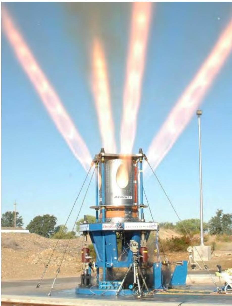
2008年7月18日，“猎户座”乘员舱抛射发动机(Jettison Motor)的同比例火箭发动机在加州萨克拉门托航空喷射设施试验。这次试验有助于美宇航局“猎户座”抛射发动机的开发，抛射发动机用于在发射期间将飞船的发射逃逸系统与乘员舱分离。
