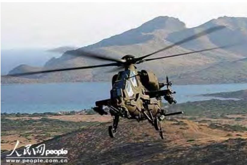
A129 型攻击直升机短翼下有 4 个挂架，可同时携带 8 枚“陶”式反坦克导弹和两个火箭发射器，机头下部炮塔内装一挺 12.7 毫米的机枪
