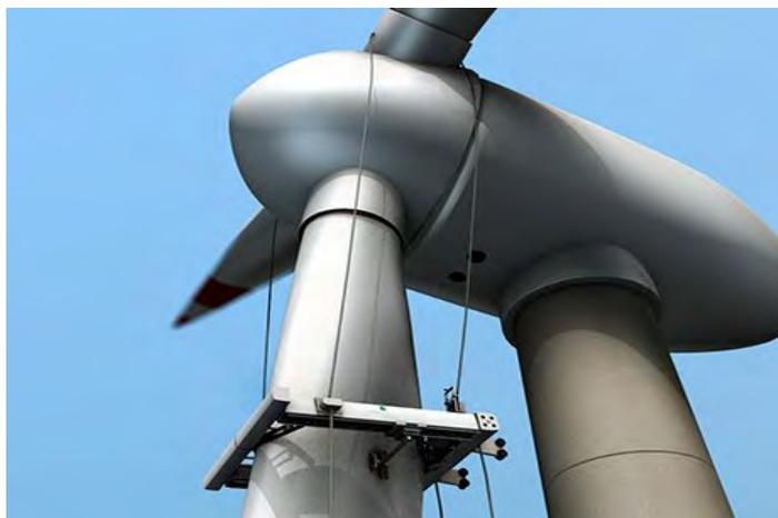
把你自己升高到 100 英尺（相当于 30 米）高的轮翼上不是件容易的事，然而随着更多的可提供可持续能量的气流涡轮机的建造，对其保养的工作需求越来越大。机器人 RIWEA 便应运而生。
