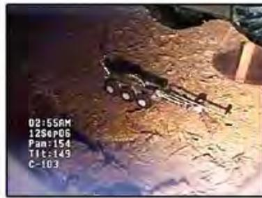
像孤独的机器人“瓦力”一样，放射性万能机则负责清理覆盖垃圾的地球环境，这种机器人被派往老化的放射性废物储存罐，这些区域是人类不能长时间逗留的。据悉，放射性万能机是由通用检测科技部门研制的，之所以将它命名为放射性万能机是由于它机尾朝下，12英寸长的探测端可插入到地面以下的储存罐。
