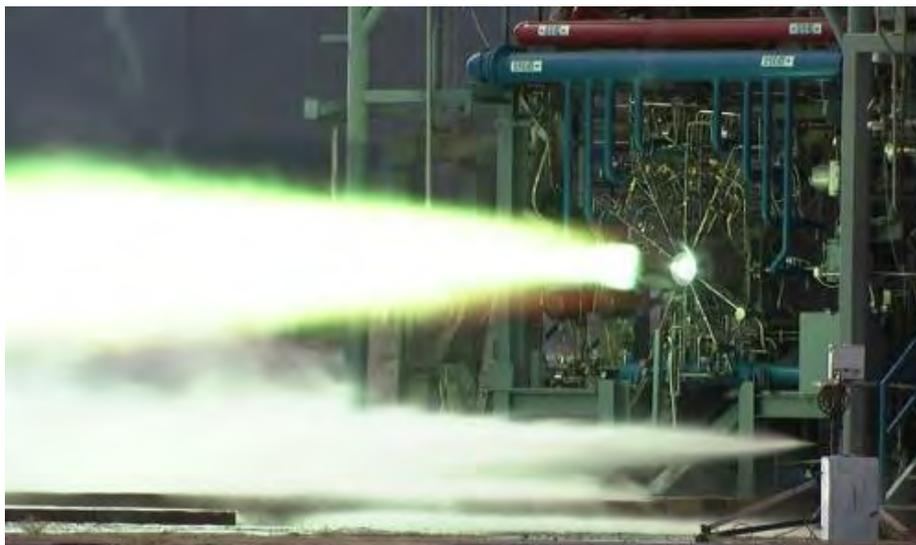
战神1号运载火箭第一级是一个由五部分构成的可重复使用的固体火箭助推器，设计源于航天飞机项目可重复使用固体火箭发动机，它使用一种称为聚丁二烯丙烯腈(PBAN)的固体推进剂。火箭的第二级或上段将采用J-2X主发动机，燃料则是液氧和液氢。这张高清录像照片显示的是，马歇尔太空飞行中心第115试验台的一台40k内部氧化物J2X喷射器的试验点火，时间是在2007年9月9日。
