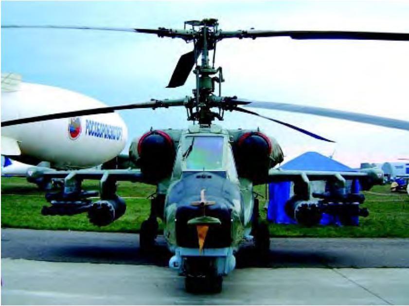
卡-50 直升机最明显的特色就是采用了共轴双旋翼布局，整个直升机看上去像一个大铁疙瘩，全身披挂，杀气腾腾
