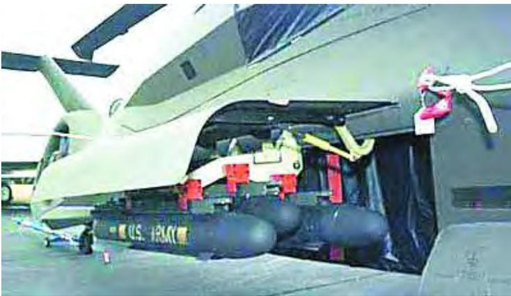
“科曼奇”每侧的弹舱门内侧有3个挂架，可挂3枚“海尔法”导弹、“陶”式导弹，或6枚“毒刺”导弹
