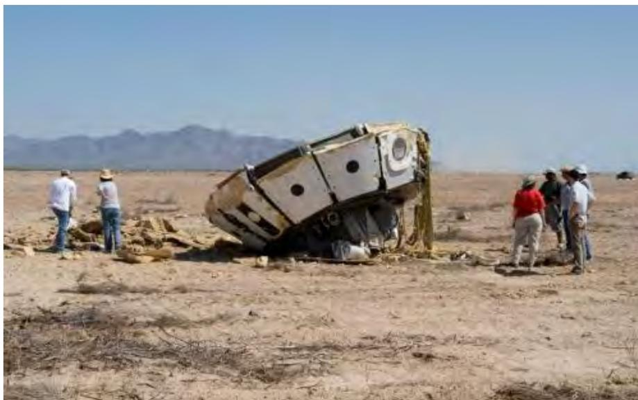
2008年7月31日，“猎户座”乘员探索飞行器模型装置在测试回收系统的降落伞系统期间严重损毁，当时，一个测试用降落伞未能适当充气，令降落伞系统失灵，造成了这次事故。未能打开的降落伞称为“程序降落伞”（programmer chute），本来用于使测试飞行装置进入正确的测试条件。
