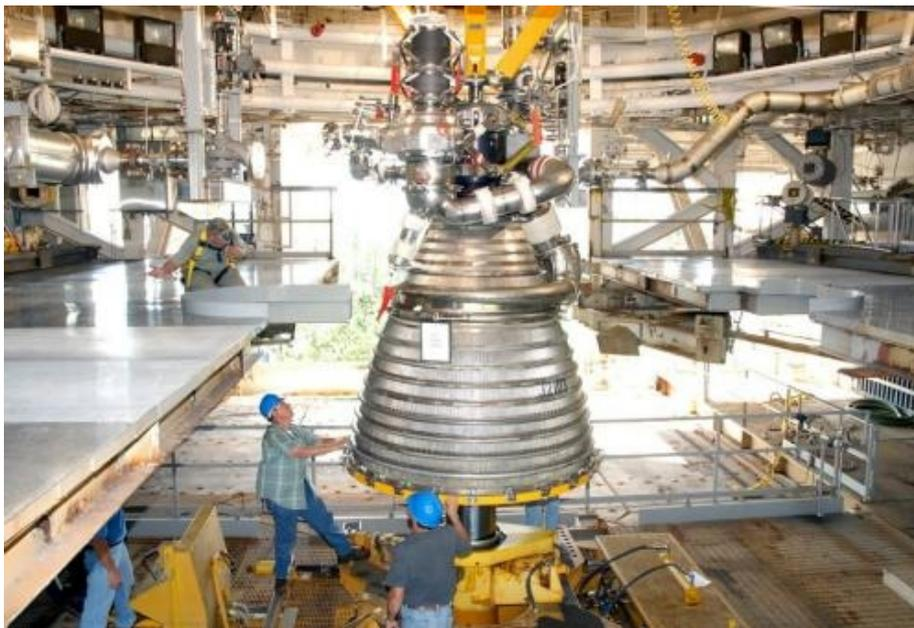
2007年9月20日，在位于密西西比州圣路易斯湾附近的美宇航局斯坦尼斯航天中心，工程师将设计用于星座计划的J-2X发动机核心组件安装到A-1试验台。这一组件称为“Powerpack 1A”，工程师在2007年11月至2008年2月间对其进行了测试。Powerpack 1A包括一个气体发生器和发动机涡轮泵，它们最早开发用于20世纪60年代末期和70年代初将美国人送上月球的阿波罗计划。工程师测试这些零部件以获取相关数据，这些数据可以帮助他们对涡轮机组进行改进，满足战神1号和战神5号火箭的高性能标准。
