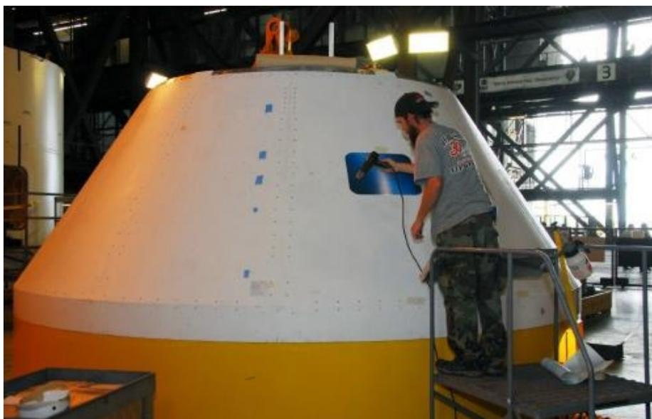
2009年2月10日，美宇航局肯尼迪航天中心飞行器装配大楼，一名工人给战神1号试验火箭模拟乘员舱涂标识。彻底完工后，这个直径为16英尺的乘员舱将为宇航员提供居住场所和再入保护。
