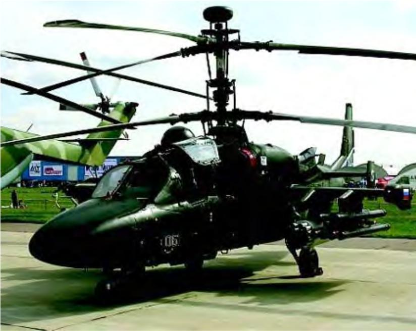
卡-52 装备有 FH01 “弩” 式雷达。该雷达装备于旋翼桨毂上方，可用于导航发现地面坦克等目标，也可用于制导半主动雷达导弹
