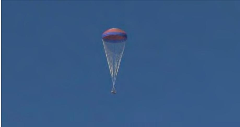
在这张高清照片中，战神火箭第一级返回降落伞的测试，于2007年9月9日在亚利桑那州尤马试验场进行。降落伞试验演示了一个三阶段展开顺序，包括使用轨道器拖拉降落伞适当地展开主降落伞。“猎户座”飞船的降落伞回收系统类似于阿波罗指令舱着陆时使用的系统，包括两个浮标、三名飞行员和三个主降落伞。
