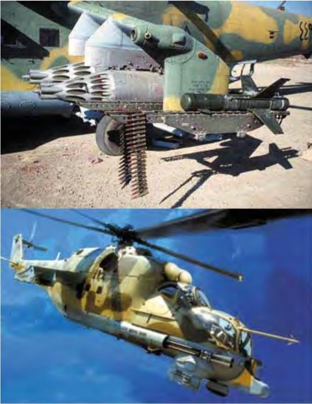
上图为米-24A 直升机的武器挂架，翼尖挂架可挂 4 枚 AT-4 反坦克导弹。下图为现代化改装的米-24V
