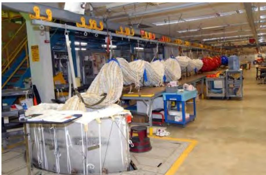
在美宇航局肯尼迪航天中心的降落伞翻新车间，一台台机器正将一个彩色的主降落伞打包，主降落伞将用于战神1号试验火箭的测试飞行。新降落伞是红白蓝三色。战神火箭定于2009年7月从肯尼迪航天中心39B发射台发射，将测试同战神1火箭相关的硬件、设施和地面活动。
