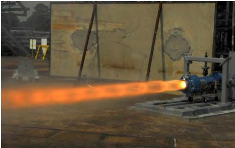
2008年9月11日，位于阿拉巴马州亨次维尔市的美宇航局马歇尔航天飞行中心工程师完成对新一代战神1号火箭一个关键发动机的第一轮测试。这个发动机是一个小型固体火箭发动机，用以帮助飞行器各级分离，提供必要的前进运动(forward motion)，促使燃料在战神1号火箭发射期间流向燃料箱底部。
