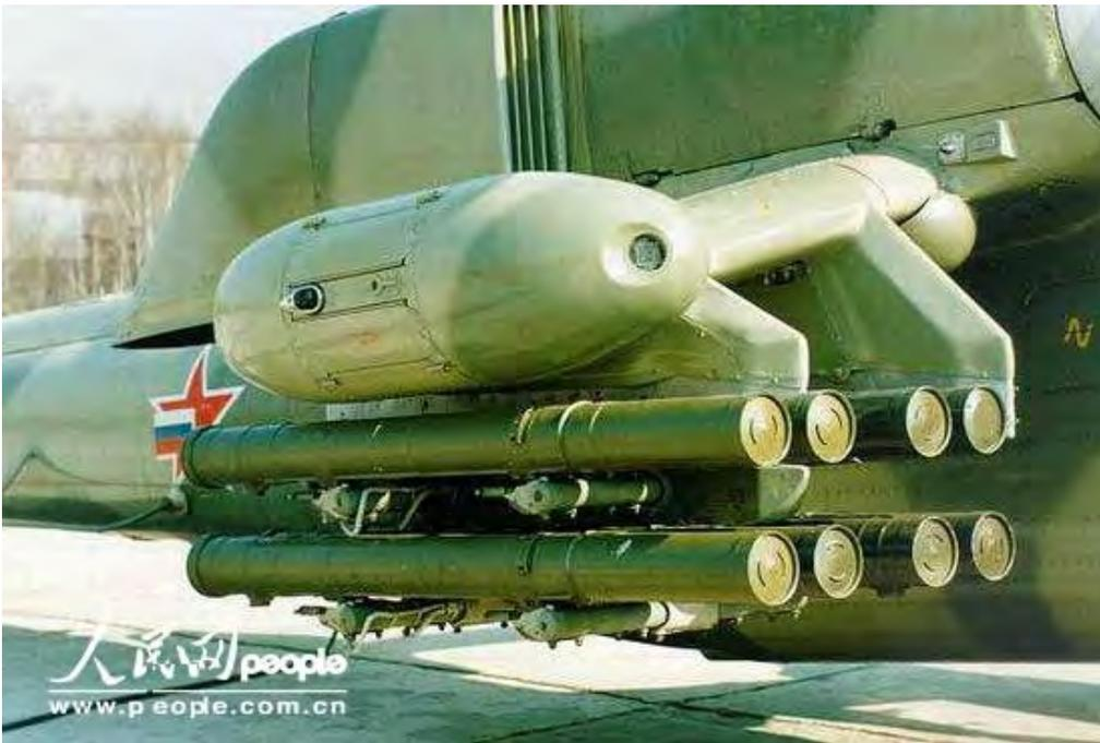
米-28N 型攻击直升机每侧短翼挂架上总共可吊挂 16 枚管式发射反坦克导弹
