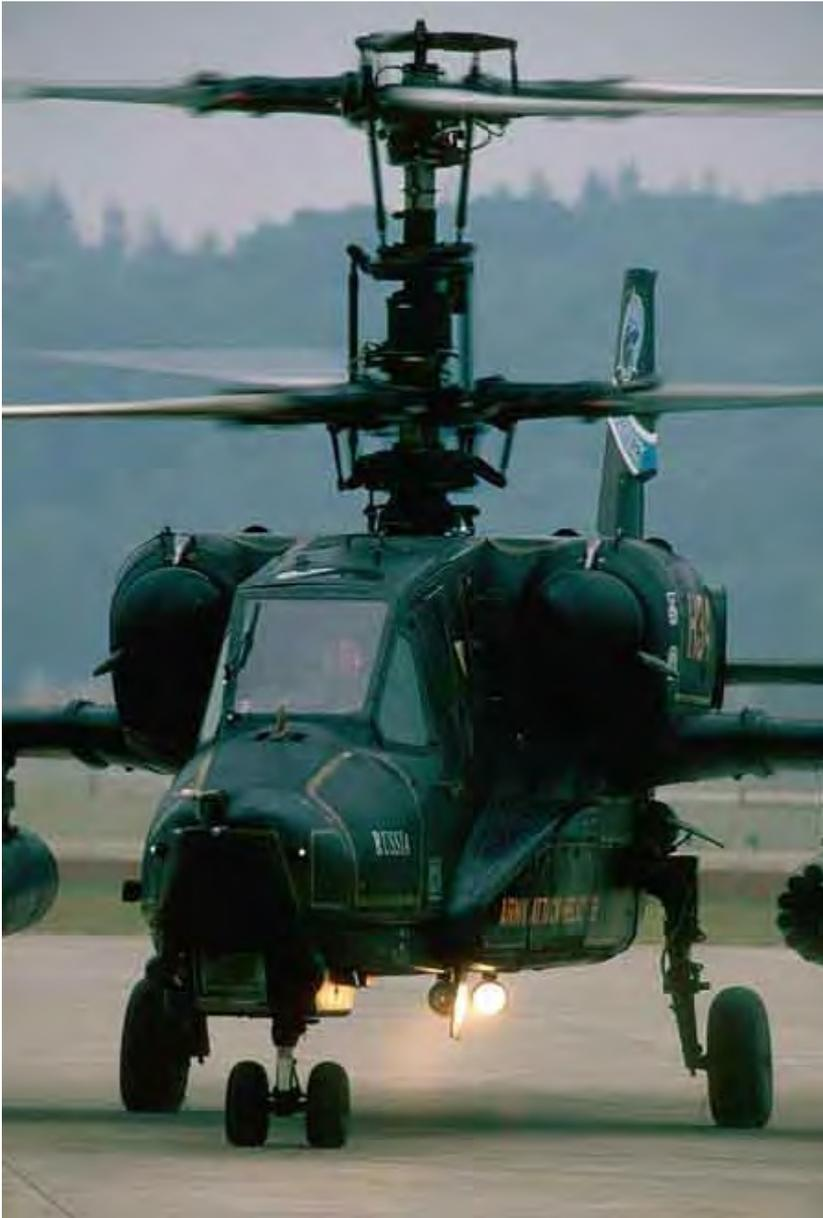
独特的双主旋翼设计，上下两组旋翼转动方向相反，以此抵消旋翼对直升机的扭力矩。直升机上也就不需要尾旋翼了
