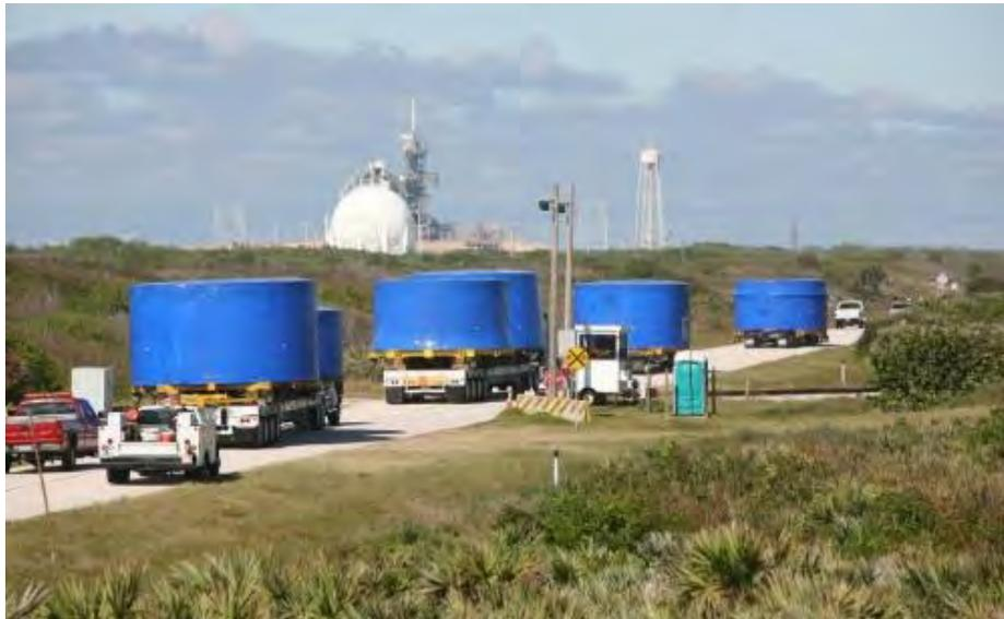
一队卡车驶离卡纳维拉尔角，前往美宇航局航天中心飞行器装配大楼4号工位，途经一个发射台。卡车上装载着战神1号试验火箭上段模拟装置，它们包着一层蓝色保护膜。模拟装置由11段构成，直径约18英尺。大多数片段的高度为10英尺左右，重量从1.8万至6万磅不等，总重量约45万磅。
