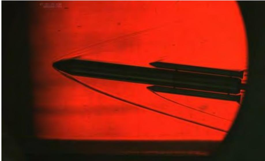
这张纹影照片拍摄于2008年10月28日，照片上是一次风洞试验，显示速度达到4.5马赫的战神5号重型运载火箭0.34比例模型上面的气流。纹影照片是用以形象化不同强度气流的方法，广泛用于航空工程学，拍摄物体周围的气流照片。
