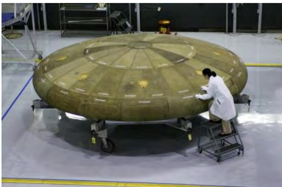
2007年11月13日，波音先进网络和太空系统公司的材料和处理工程师伊丽莎白·楚(Elizabeth Chu)检查热防护系统制造示范装置。这一装置是为美宇航局“猎户座”乘员探索飞行器项目开发。波音先进网络和太空系统公司同美宇航局签署了开发热屏蔽系统原型
