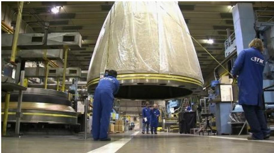
2008年2月15日，美宇航局工程师正在犹他州一处设施内将O形圈安装在战神载人运载火箭(CLV)第一级火箭尾端喷嘴组(nozzle section)上。
