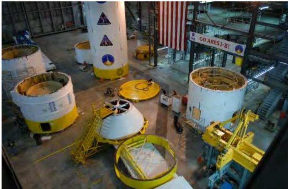
在佛罗里达州美宇航局肯尼迪航天中心飞行器装配大楼4号工位内，战神1号试验火箭乘员舱模拟器同其他火箭片段一样，在进一步测试和最终组装前被放到地上。
