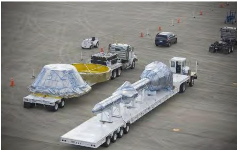
战神1号试验火箭模拟乘员舱和发射逃逸系统的飞行设备运抵美宇航局肯尼迪航天中心。这一设备将装在战神火箭的顶部。设备上近150个传感器将测量火箭顶部的气动力压和温度，汇总到飞行器加速度和攻击角落的测量数据中。这些数据将有助于美宇航局了解
