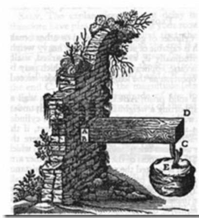
图2 伽利略《关于两门新科学的对话》中悬臂梁的插图
