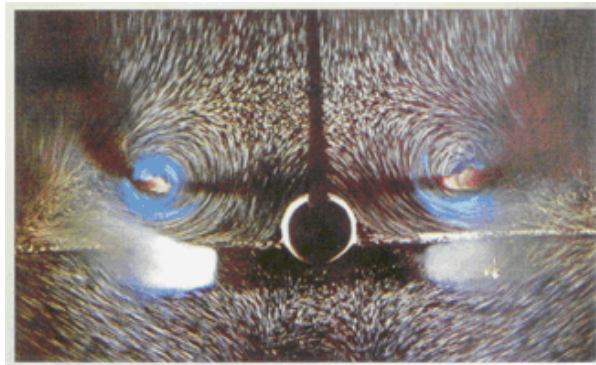
飞机着陆时气流场中的涡旋。这是协和式飞机着陆时流场中涡旋的正视图。
