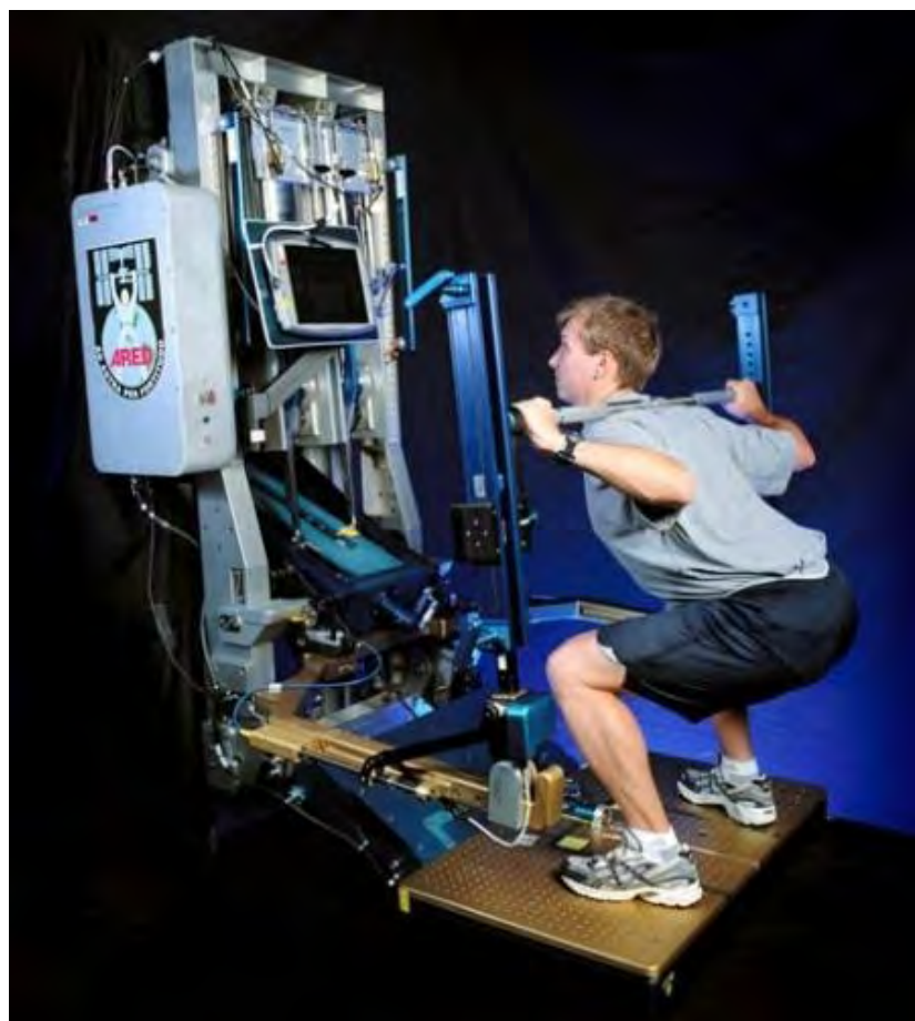
安装在空间站上的新健身器 ARED，这是在地面上测试的情景
