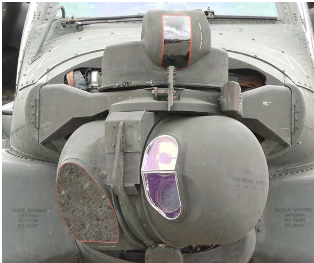
阿帕奇机头安装的标截获指示瞄准具/驾驶员夜视传感器
