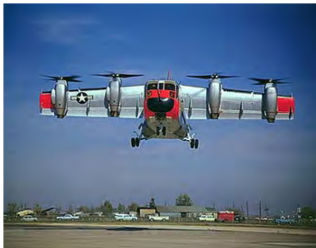
早期倾转机翼发展得最远的还要数 Vought Hiller Ryan 三家合作的 XC-142，美国军方对 XC-142 也寄予深望，空军、陆军和海军联合研制，这是又一个 Tri-Service 项目/XC-142 起飞到平飞的过程
