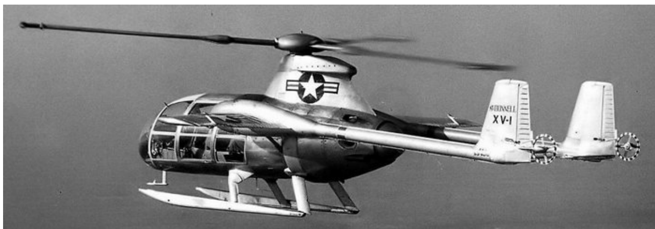
麦克唐纳在从德国“俘虏”过来的喷气翼尖鼻祖 Feiedrich von Doblhoff 的主持下，在 50 年代研制了 XV-1 研究直升机，除采用喷气翼尖外，还在机身尾部单独采用推进螺旋桨提供推力，尾撑顶端的小型螺旋桨用于方向控制
