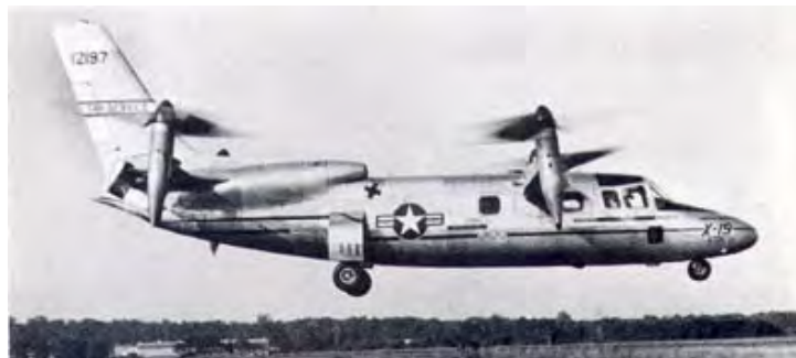
Curtiss Wright X-19 在悬停中，前后左右的四台发动机用于悬停中的姿态控制。为了避免陀螺力矩，左前、右后和左
