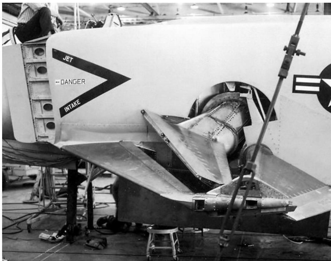
鸭翼上打开的百叶窗和喷气导管清晰可见
