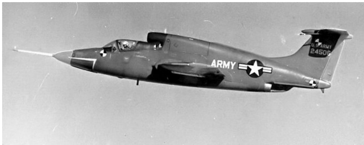
平飞时，机翼上下表面的风扇盖板关闭，减小机翼阻力
