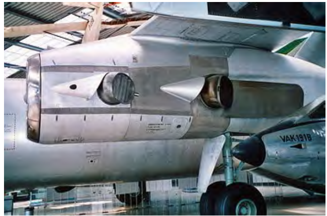
翼尖升力发动机的好处是不占用机内体积/翼下升力-巡航发动机的细节
