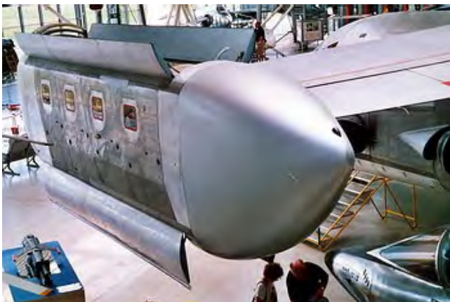
翼尖的升力发动机细节/打开的翼尖升力发动机排气口
