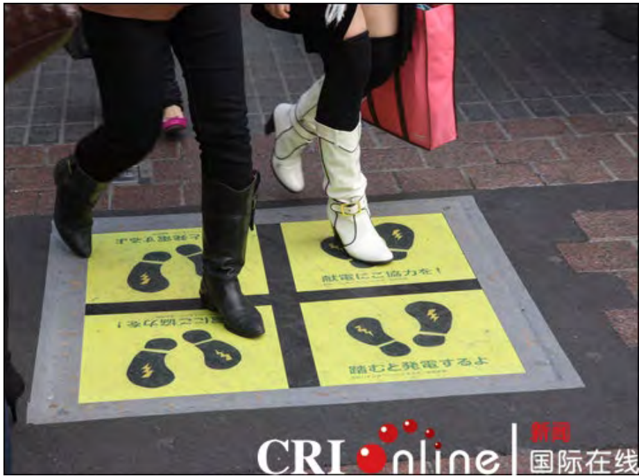
“发电地板” 走过踩过就可随时发电
