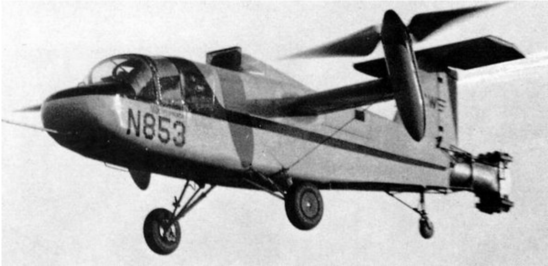
Curtiss Wright X-100 是 X-19 的先驱，只有两台发动机，采用导至机尾的发动机废气喷管提供姿态控制，效果不好
