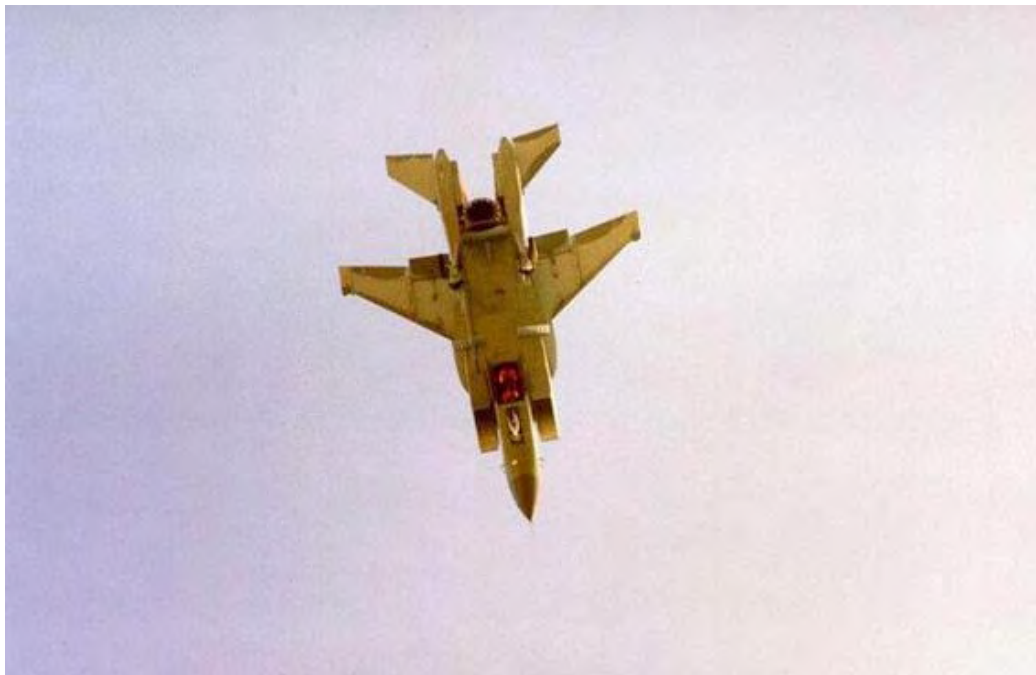
雅克-41在较高高度悬停，可以看到升力发动机正在工作。较长的尾撑和双垂尾是配平全机重心的需要
