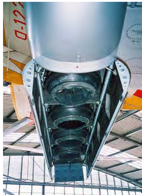
翼尖的升力发动机细节/打开的翼尖升力发动机排气口
