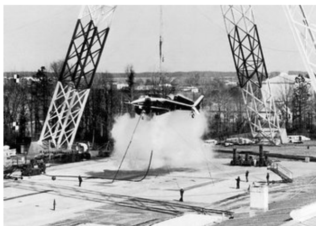
XFV-12 正在准备系留试验/XFV-12 完成了系留状态下的悬停试验，但还没有进入到自由飞状态下的悬停试验，就下马了
