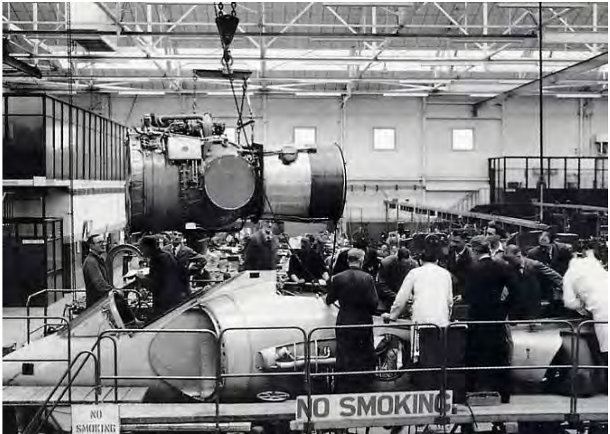
“飞马”发动机首次装入 Kestrel 研究机
