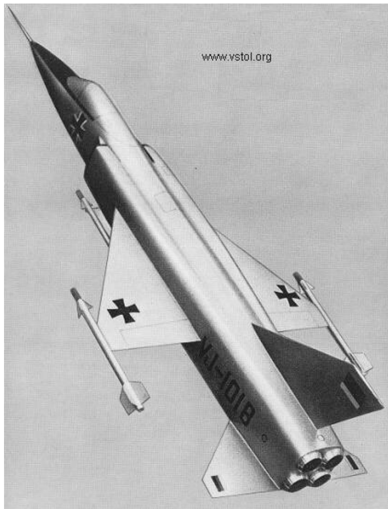
采用 4 台升力-巡航发动机加一台升力发动机
