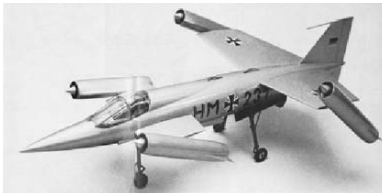
Heinkel He 231的翼尖倾转升力-巡航发动机是VJ-101的翼尖发动机的灵感的来源
