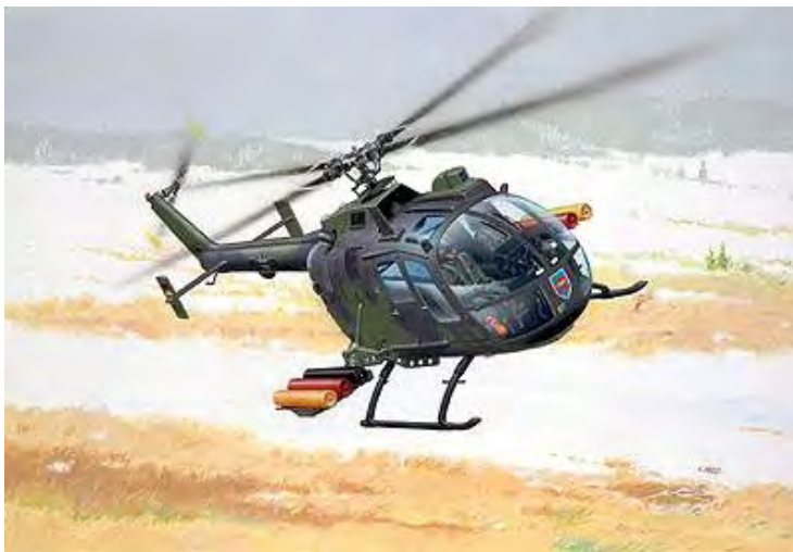
第一个采用无铰桨叶的Bo-105/Bo-105的无铰桨叶，用弹性元件代替了挥舞铰和摆振铰，但变距铰依然保留
