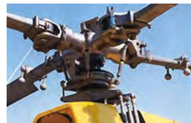
第一个采用无铰桨叶的Bo-105/Bo-105的无铰桨叶，用弹性元件代替了挥舞铰和摆振铰，但变距铰依然保留
