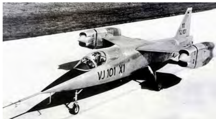
采用 4 台升力-巡航发动机加一台升力发动机
