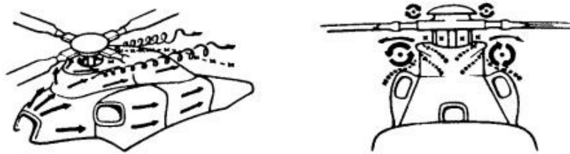
发动机舱周边有马蹄形流/发动机舱两侧也有横向的涡流
