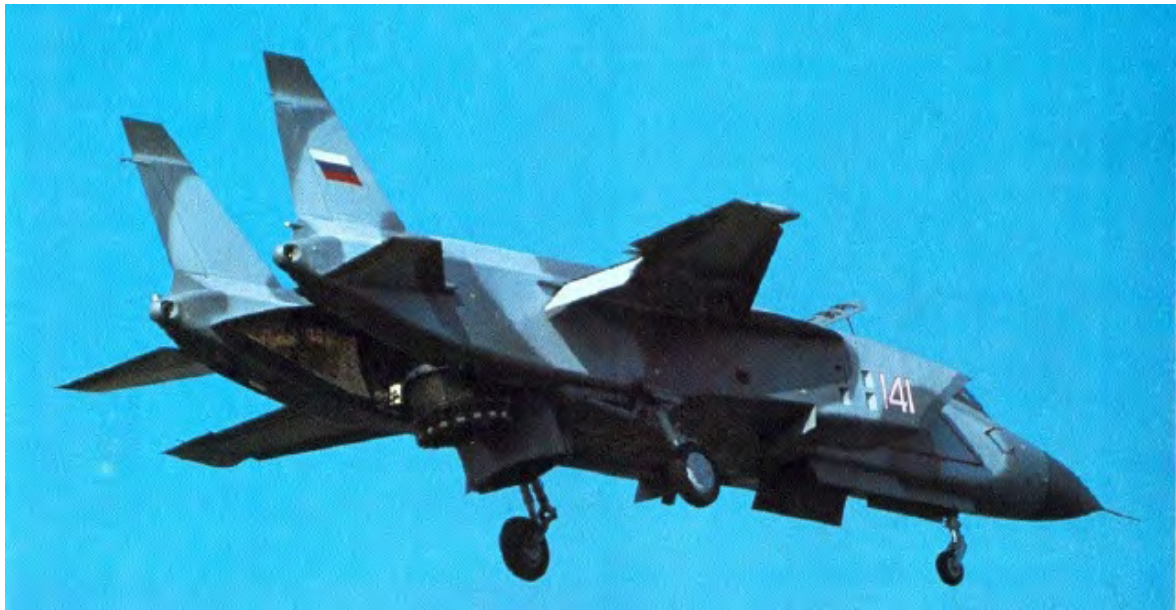
雅克-41（也称雅克-141）是吸取雅克-38的经验后研制的，本来有望成为第一架实战型超音速垂直起落战斗机，图中可以清楚地看到尾矢量喷管转到垂直起落状态，升力发动机的进气门、排气门也已经打开
