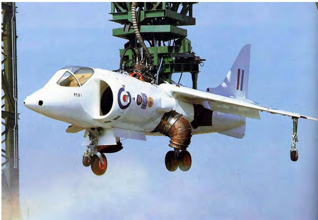
罗尔斯·罗伊斯和BAe正在试验PCB（Plenum Combustion Chamber，增压燃烧室）
