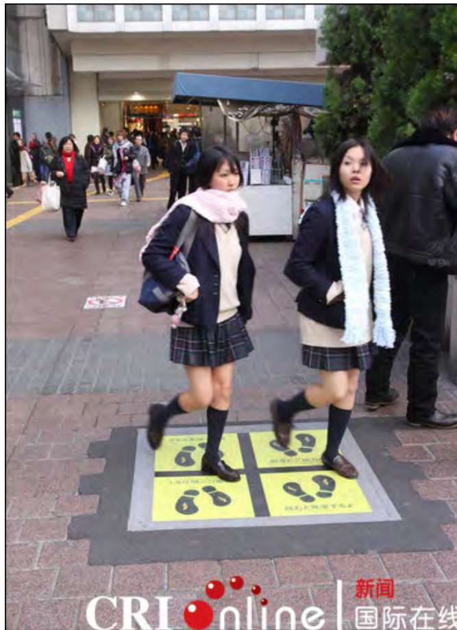
“发电地板” 走过踩过就可随时发电
