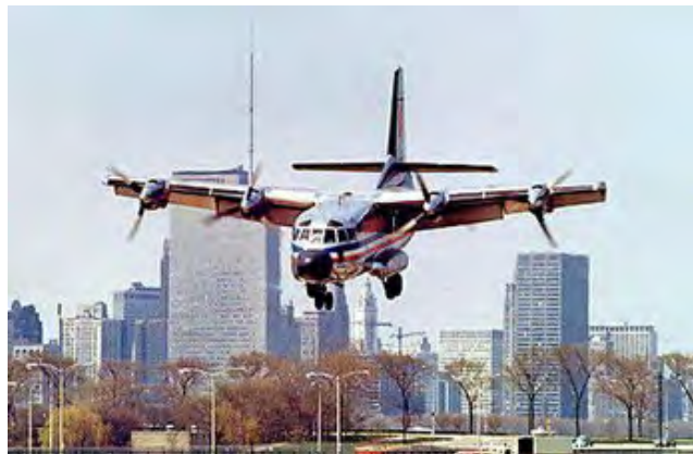
但是实用型的升力襟翼还是法国人先走一步，借助升力襟翼技术，布雷盖 941 已能够在特别窄小的场地起落著称/在美国，美航（American Airlines）也对把布雷
