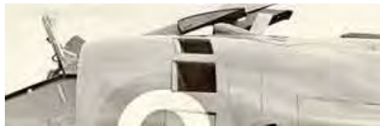
进气口旁的辅助进气口，用于垂直起落时增加进气量
