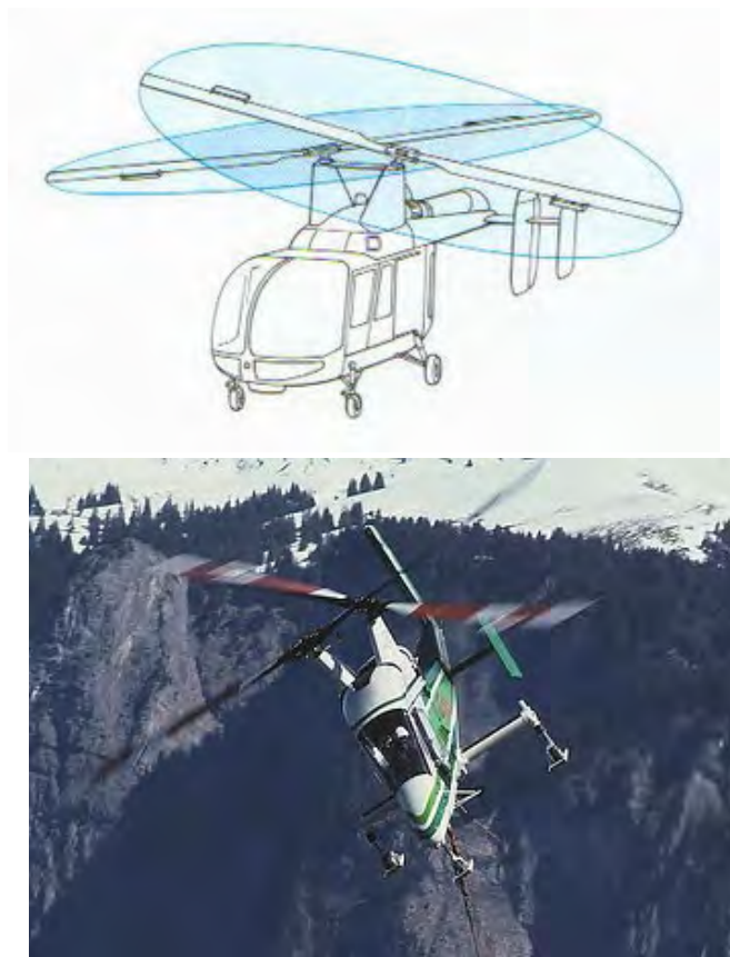
交替双桨示意图/交替双桨的K-Max
