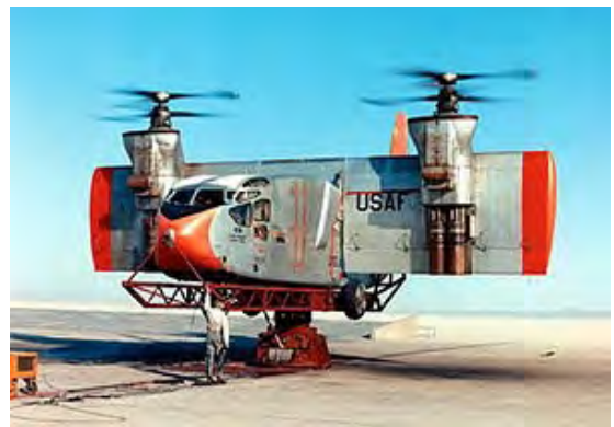
但在机翼竖起来时，发动机推力向下，产生直接升力，而且机翼对发动机的下洗气流的遮挡很小/早期直升机界很活跃的 Hiller 也推出了 X-18 研究机，图中为地面演示机翼的倾转
