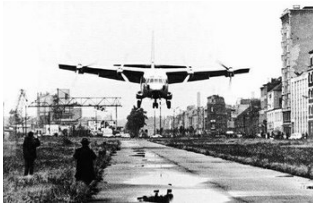
Fairchild 224 VZ-5 更进一步，前机身有一个自然的30度上仰，进一步增强增升效果，T形尾顶端后有一个小螺旋桨，用于悬停是辅佐姿态控制
