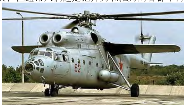
米-6的短翼用于在平飞时产生升力，为旋翼卸载/AH-64的短翼同时兼作武器挂架，一物两用
