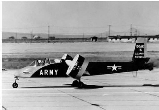
Doak VZ-4 是采用倾转涵道风扇的先驱/水平的涵道本身可以产生升力，但倾转过程中，涵道唇部会出现失速
