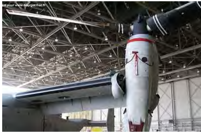
v-22 的半刚性旋翼清晰可见/v-22 的宽弦、大弯度、无铰、无轴承桨叶清晰可见
