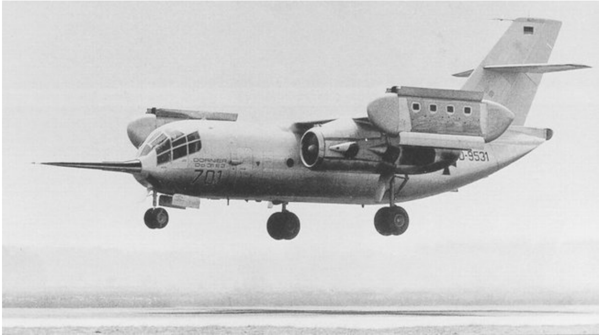
Do.31 在悬停中，可以清楚地看到所有升力发动机门都打开了
