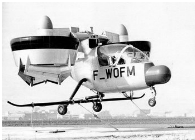
四个大水桶一样的涵道风扇在空中翻转，也是一景/法国的 Nord（后并入 Aerospatiale）也研制了 Nord 500 Cadet，发动机推力和涵道出口的菱形导流片提供悬停状态下的姿态控制
