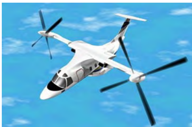
意大利 Agusta 推出的 ERICA 计划不仅仅是又一个倾转旋翼的方案，ERICA 的机翼外翼段倾转，使其介于倾转旋翼和倾转机翼之间，不过现在 ERICA 已经和 Eurotilt 合并了
