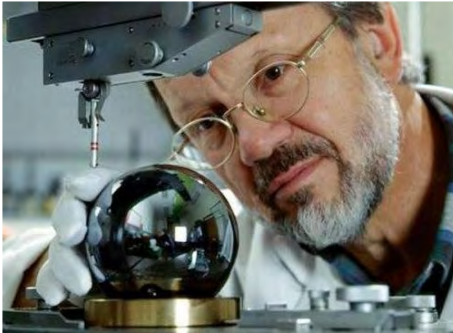
科学家正在检测世界上最圆的物体——硅晶体
