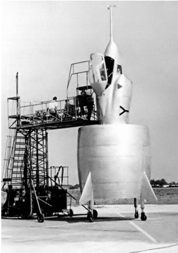
法国对 Tail Sitter 的概念很感兴趣，SNECMA 设计了这个采用奇特的环形翼的 C450 Coleoptere 研究机/C450 在起飞
