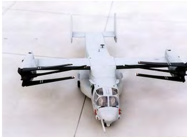
起飞、着陆时，襟翼放下，最大限度地减小对下洗气流的遮挡/ 为了适合上舰的需要，v-22 的旋翼可以折叠，机翼还可以横转 90 度，和机体平行，以节约占地空间
