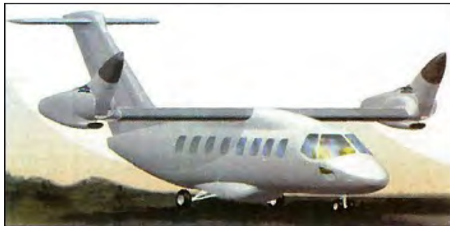
法国主导的 Eurotilt 倾转旋翼飞机方案
