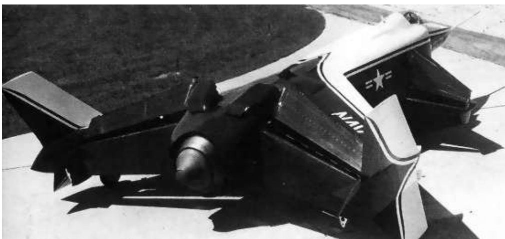
机尾的“塞”式喷管，在垂直起落状态下，主喷管关闭，喷气流通过导管导向机翼和鸭翼内的引射增升装置
