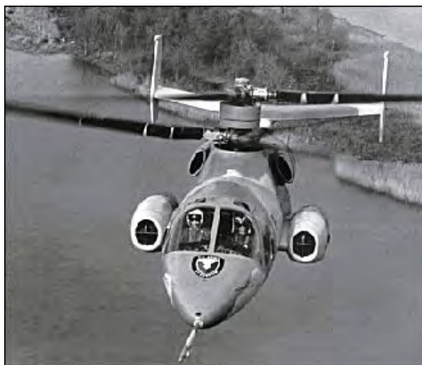
西科斯基 XH-59A “前行桨叶”概念研究机，用共轴反转的刚性旋翼，既抵消扭力，又抵消非对称升力
