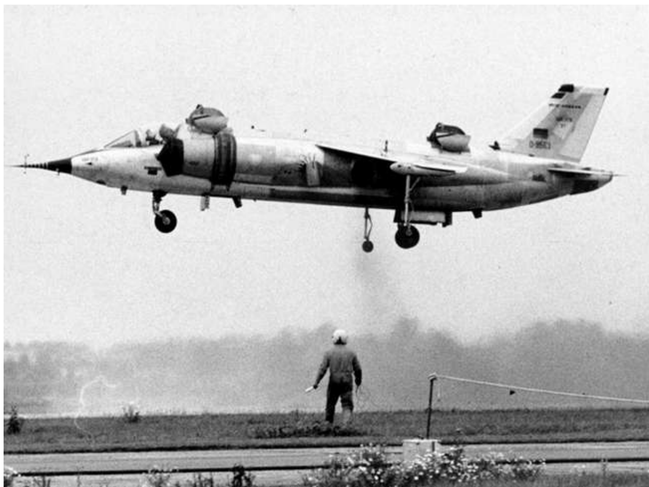
VAK-191 在垂直起飞，注意其打开的升力发动机进排气口
