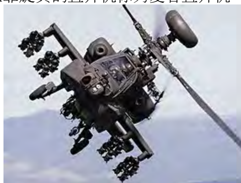
米-6的短翼用于在平飞时产生升力，为旋翼卸载/AH-64的短翼同时兼作武器挂架，一物两用
