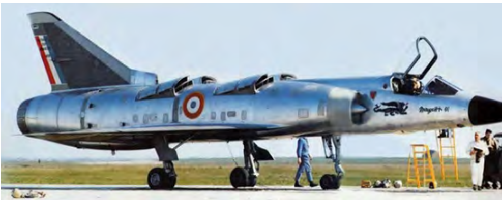
幻影 III V 试过两种升力发动机的进气门：开门式（前图）和勺式（本图）
