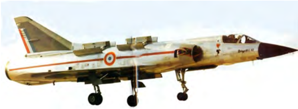
幻影 III V 在悬停中，可以清楚地看到机背打开的进气门
