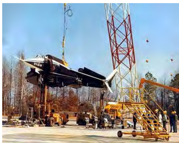
XFV-12 正在准备系留试验/XFV-12 完成了系留状态下的悬停试验，但还没有进入到自由飞状态下的悬停试验，就下马了
