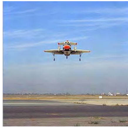
机翼实际上还是符合气动升力的要求的，就是特别肥厚了一点
