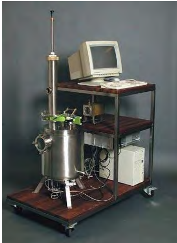
丹麦奥尔胡斯大学进行的火星环境模拟舱实验
