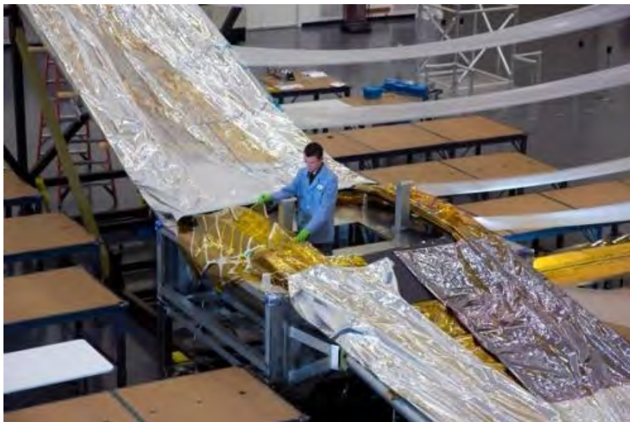
设计人员正在检测遮阳板的涂层
