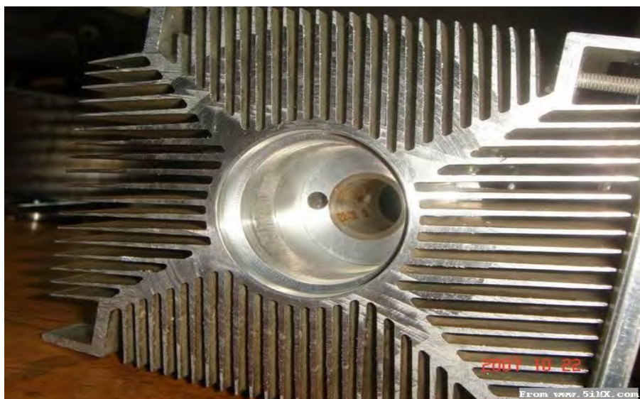
manson 发动机内部结构后视，注意气缸（注射器管）上有孔
