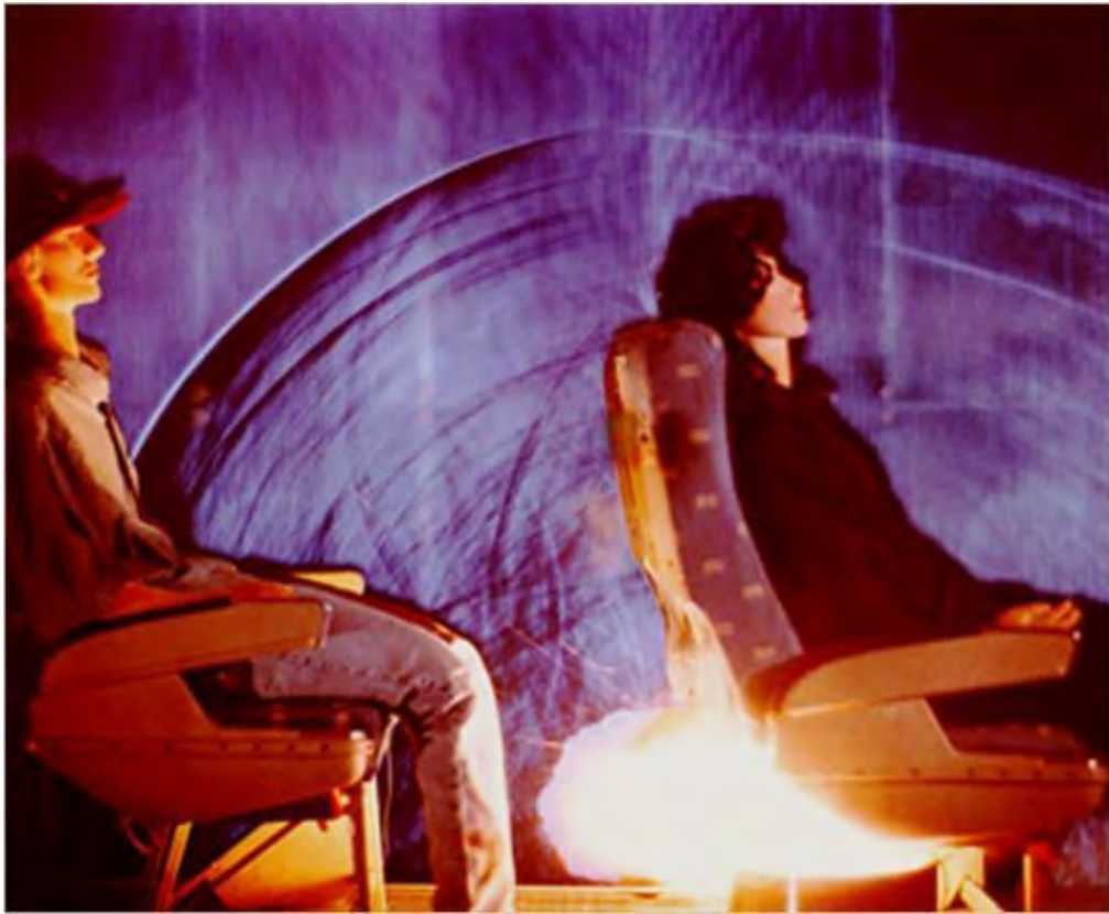
1.这张照片上显示的，是利用人体模型在一个实物大小的飞机舱内模拟爆炸场面。该照片捕捉到爆炸发出的光和充斥整个机舱的冲击波。
