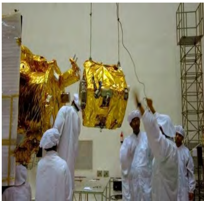
工程师正在将月球撞击器安装到探月卫星上
