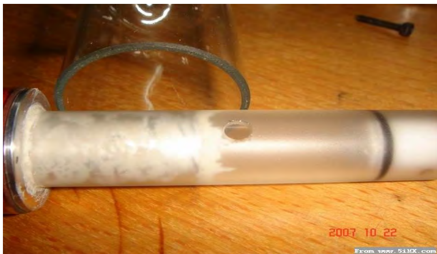
manson 发动机内部结构后视，注意气缸（注射器管）上有孔
