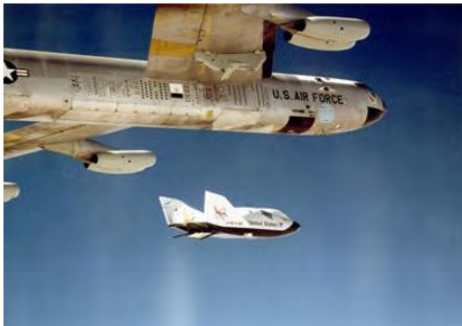
B-52 母机空中发射 X-38 飞行器
