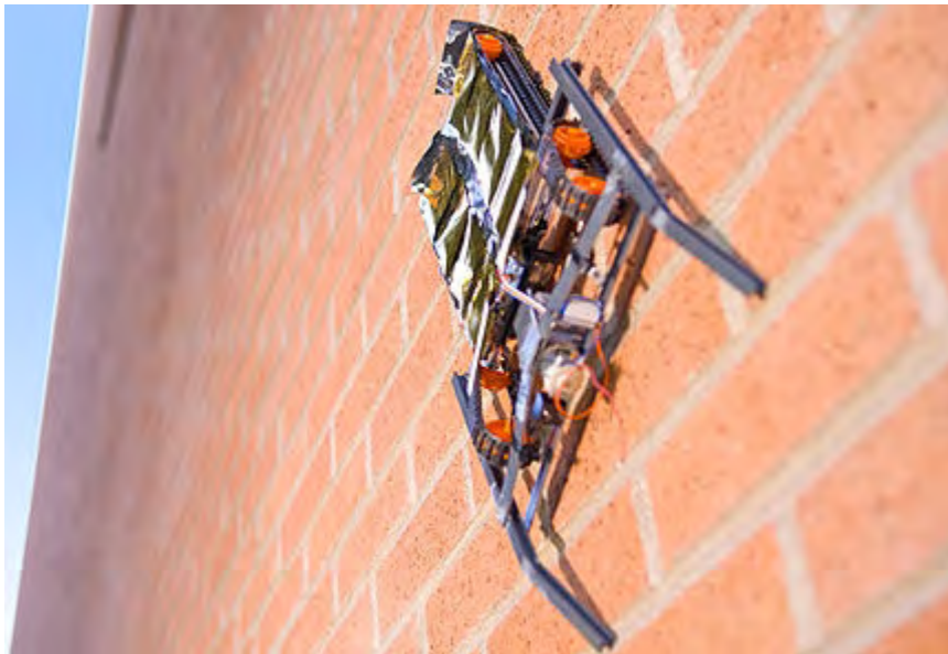
新型机器人依靠静电产生的吸引力吸附在墙面上
